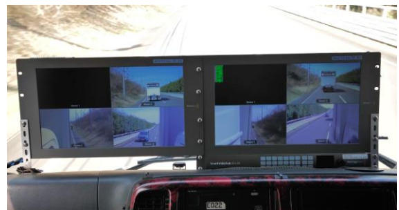
先頭車両の運転席には、2台目以降のカメラ映像が5Gで低遅延伝送され表示される。
