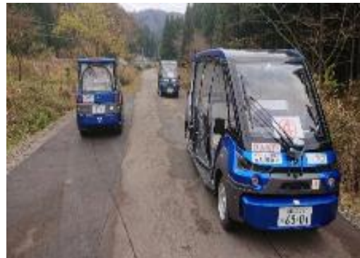
1人の遠隔監視・操作者が3台の無人自動運転車両を運行
