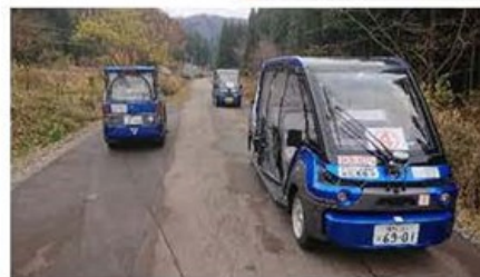
1人の遠隔監視・操作が3台の無人自動運転車両を運行
