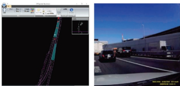
図7 合流時の本線状況(ドラレコ映像)とダイナミックマップビューアでの表示
