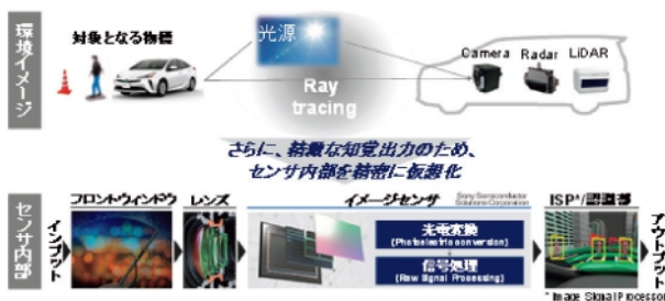
図3 空間伝搬を再現するセンサモデル(カメラの例)
