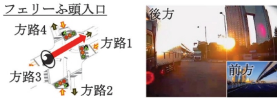
図8 順光で信号灯色認識が困難となる状況(例)
