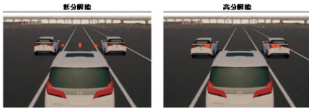
図7 ミリ波レーダ方位角分解能の影響
