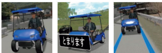
図7 外向けHMIの装備と路面標示の敷設
