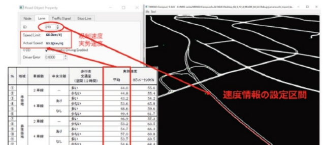
図11 道路情報における規制速度と実勢速度の設定
