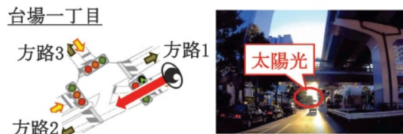
図7 逆光で信号灯色認識が困難となる状況(例)
