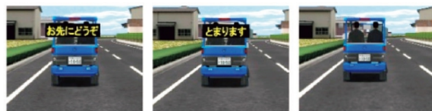
図8 外向けHMIによる意図・状態の伝達
