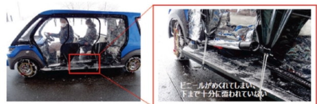
図13 車両附属のビニールカーテン設置状況
