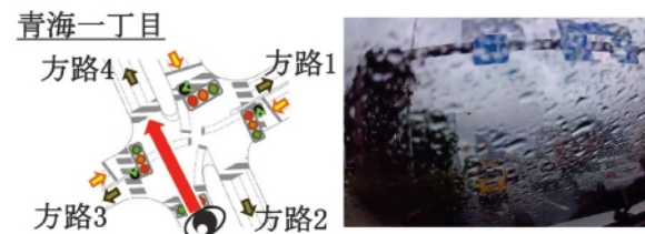
図12 雨滴で信号灯色認識が困難となる状況(例)
