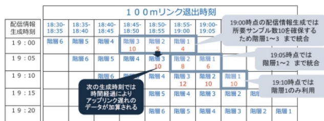
図9 アップリンク遅れを考慮したデータ収集方法の概念
