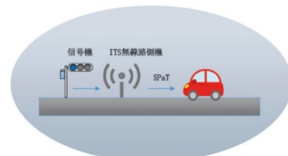
図3 V2Iシステムの概要
