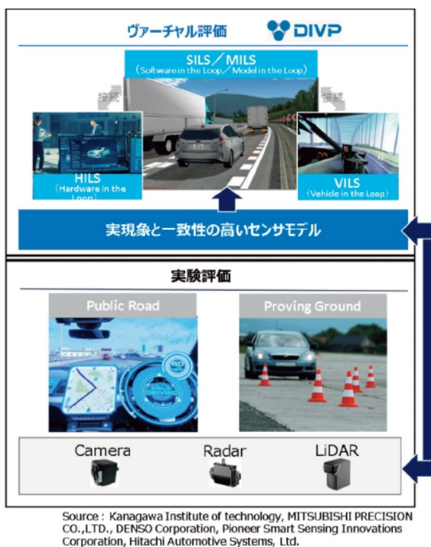
図1 DIVPのセンサーモデルの一致性検証
