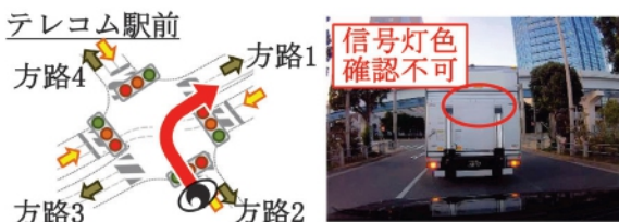
図9 隠蔽・遮蔽で信号灯色認識が困難となる状況(例)
