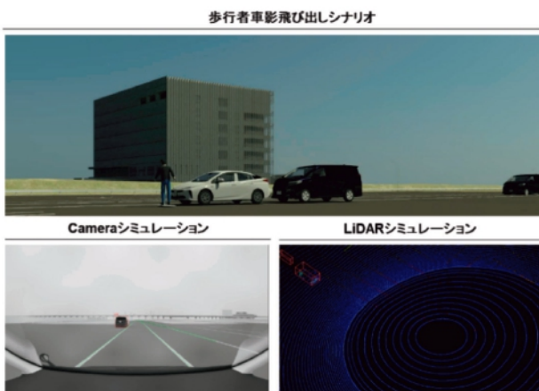
図16 NCAP車両陰からの歩行者飛出しシナリオ時のシミュレーション
