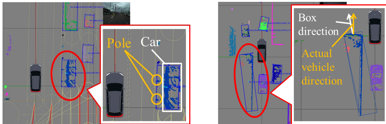
(a) クラスタリングの失敗による速度ベクトルの誤認識
