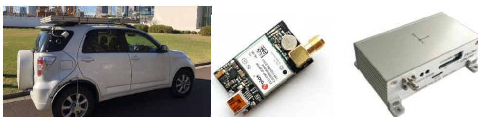
図 2.3.①-1 データ収集を行った車両の外観，Ublox 社 F9P と多摩川精機社 TAG264
