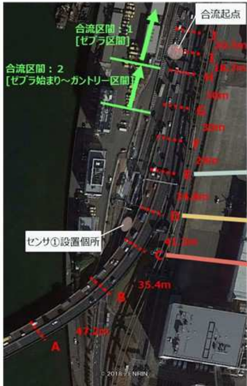
図4. 1. 1. 合流支援情報のセンサ設置位置検証のための ラップタイム分析要領
