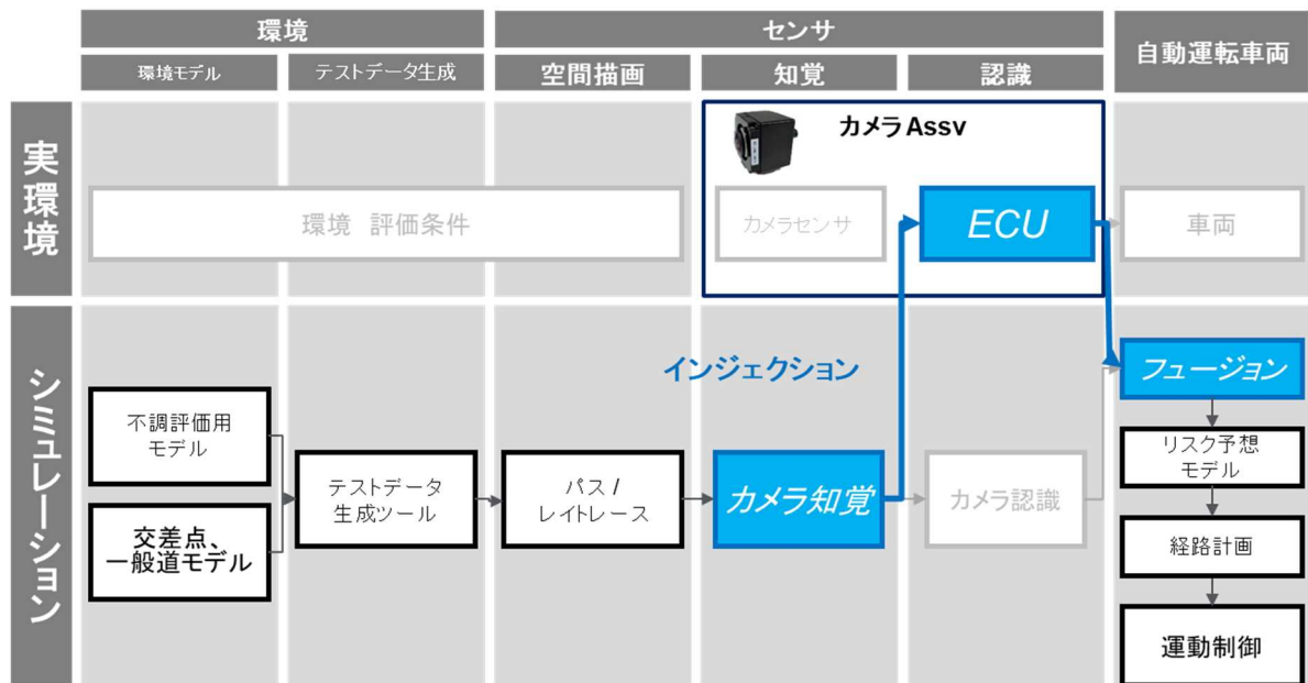
Figure 48 カメラ HILS 構成
