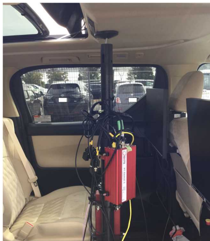
Figure 145 GNSS/IMU の搭載写真
