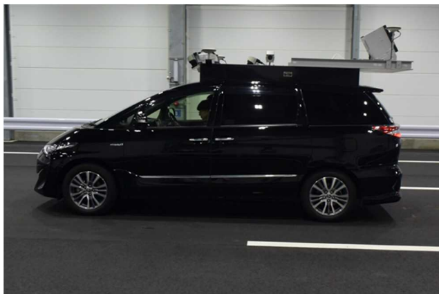
Figure 15 高密度レーザーを取り付けた MMS 車両
