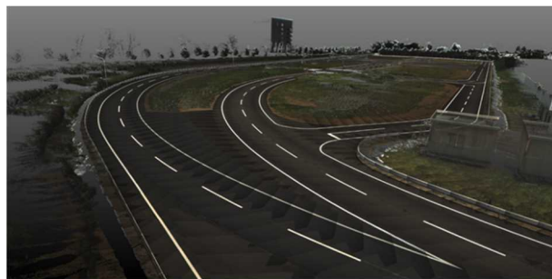
Figure 17 実測した点群データ(多目的市街地)
