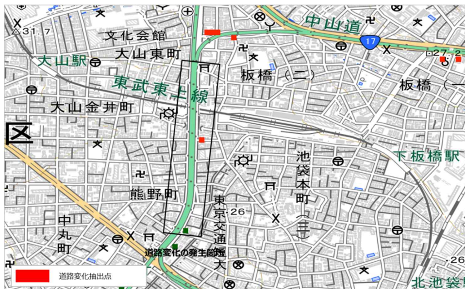
図 2-43 道路変化点の検出結果（閾値強）【#2 板橋・熊野町 JCT 間】
