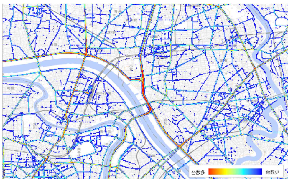
図 2-32 道路変化後の車両分布パターン【#1 堀切・小菅 JCT 間】
