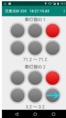
図 3-5 模擬車載機での信号予定情報の表示例
