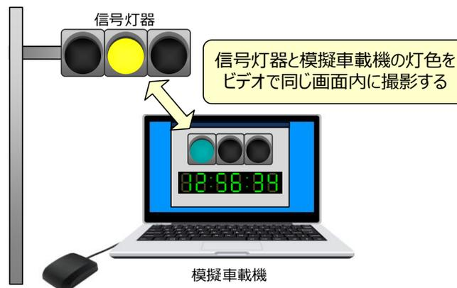
図 3-9 信号予定情報提供の精度検証の構成
