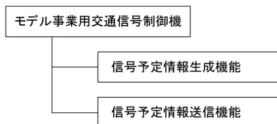
図 4-2 信号情報配信装置ソフトウェア構成
