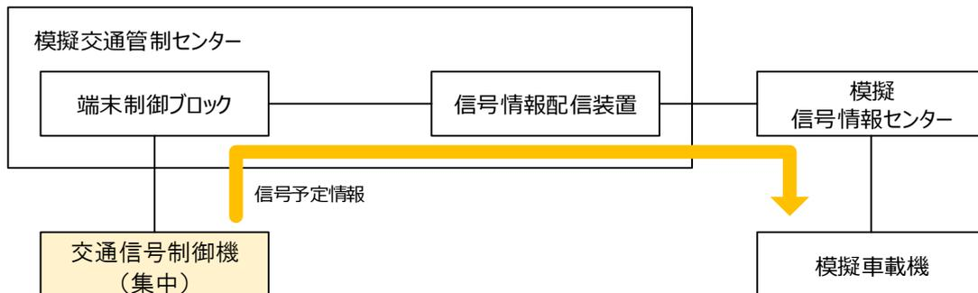
図 3-3 集中方式②のシステム構成概要図
