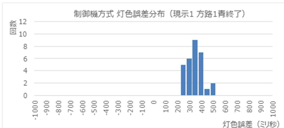
図 5-21 信号灯色と信号予定情報の誤差の分布（制御機方式 現示 1 方路 1 青終了）
