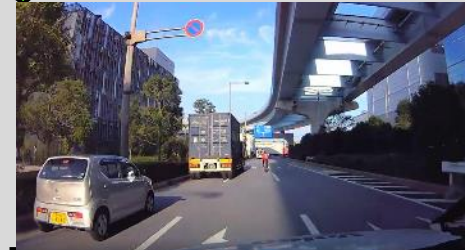
前方にスポーツタイプの自転車を検知、急制動(約-0.44G)
