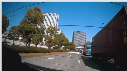
信号器や前走車(バイク)を検知して減速を開始(停止線から72m手前)
