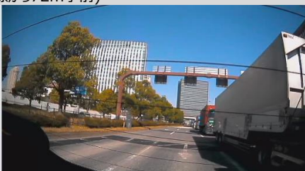
信号器や前走車(バイク)を検知して減速を開始(停止線から72m手前)
