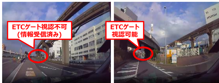
図：前アンテナ情報受信済み・ETCゲート視認不可(左)、ETCゲート視認可能(右)
