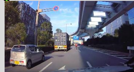
前方にスポーツタイプの自転車を検知、急制動(約-0.44G)
