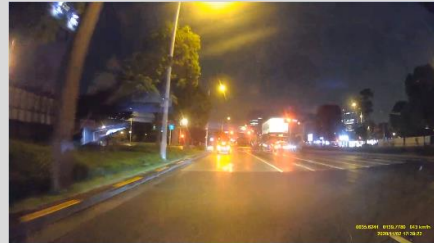
↓ 交差点待ちしている車両を検知し、さらに減速開始
