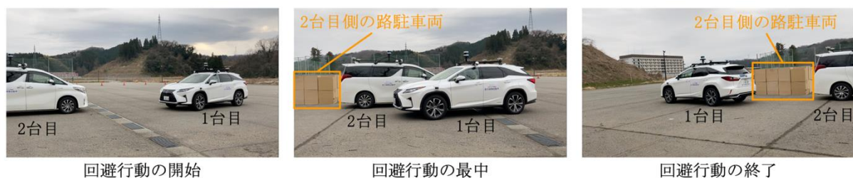
図 2.5.①-14 シーン 3 を実車試験にて検証
