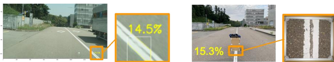
図 2.3.③-2 剥離率の自動推定値（左図）と手動計測値（右図）の比較
