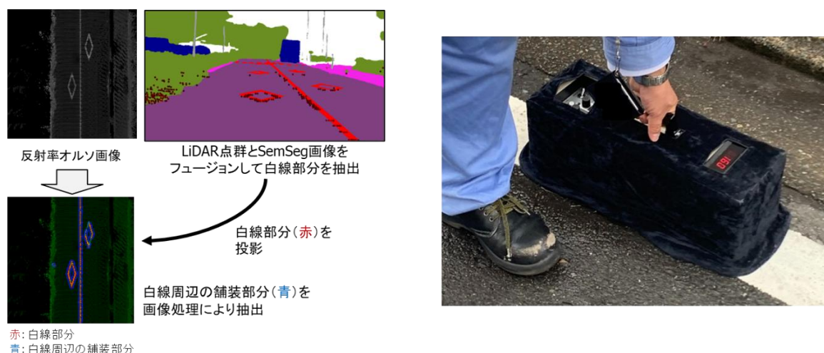
図 2.3.③-4 白線反射率および反射率コントラストの 自動推定値（左図）と手動計測値（右図）の取得の様子
