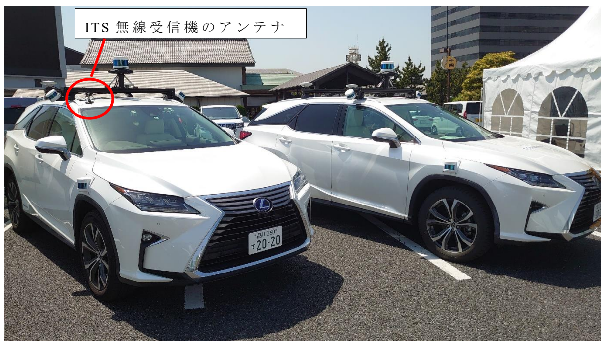
図 2.6-3 車両上部に設置した ITS 無線受信機のアンテナ
