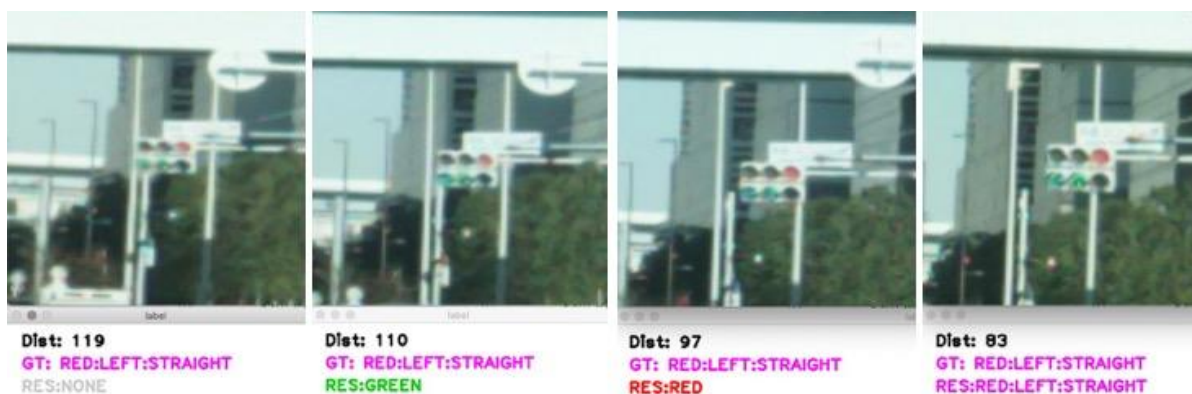
図 2.1.①-3 通常画角カメラでの交差点接近時の個別信号機認識の誤認識例 (Dist: 信号機との距離，GT: 正解ラベル，RES: 出力状態)
