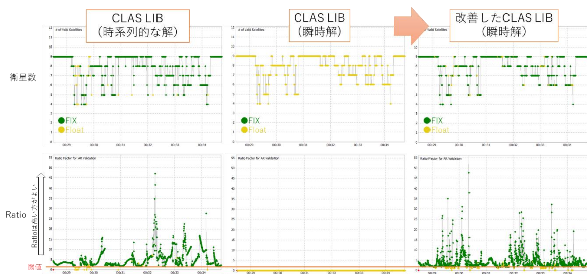
図 2.3. ①-2 CLAS LIB の評価の際の衛星数と Ratio
