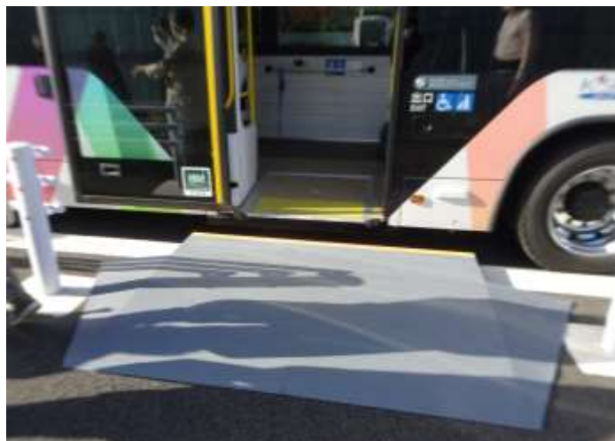
図 3 晴海 BRT ターミナルのサブバースに設置した可搬型乗降台
