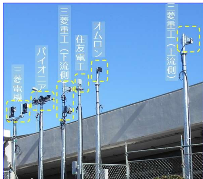
図 4.2-1 センサ①設備（国総研共研 5 社の各路側センサ）
