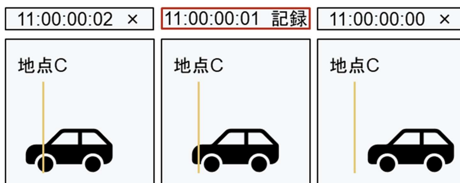
図 5.2-4 通過した瞬間のフレームが存在しない場合の車頭通過判定の例
