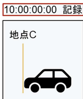
図 5.2-3 車頭通過判定の例
