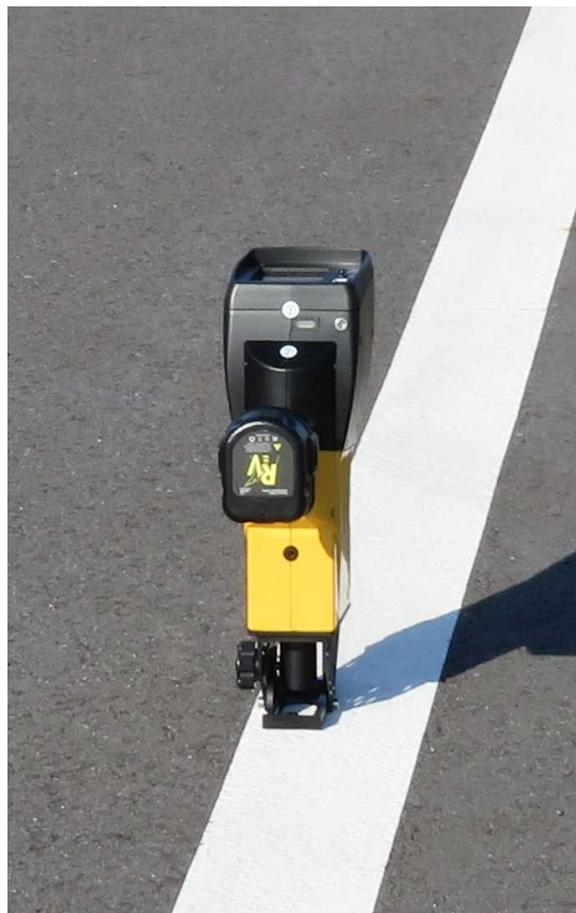
モバイル再帰反射計測器
