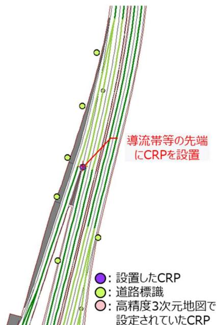
図 2-45 CRP の設置位置 (高精度 3 次元地図への重畳)
