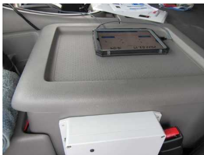
キャブに設置した制御BOX（白色の箱）と表示器
