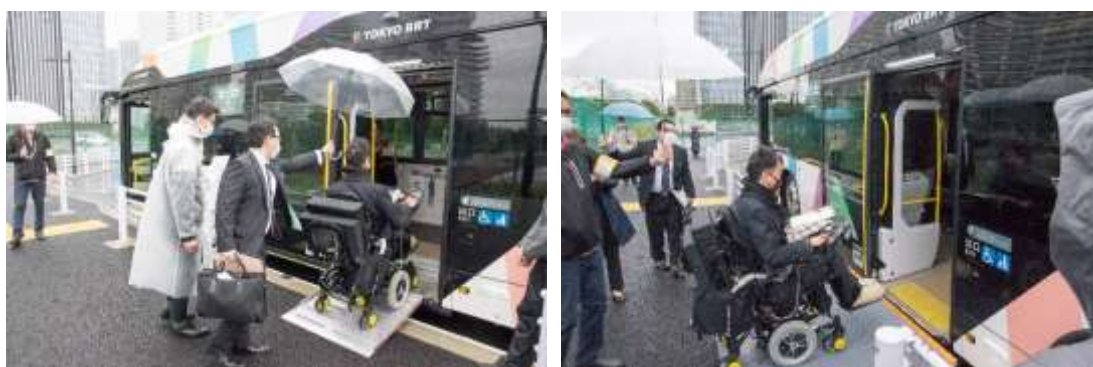
図 3-49 通常の停車（左図）と手動正着・自動正着（右図）の中扉の様子
