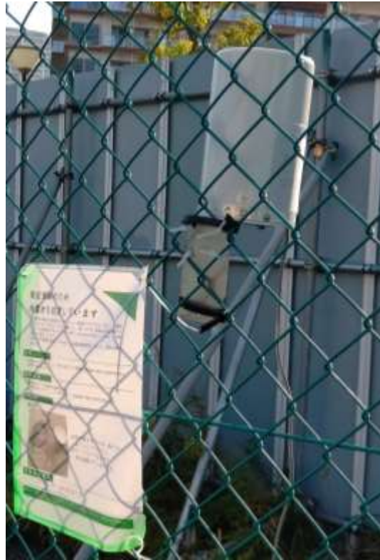
図 3-3 設置した雨量計
