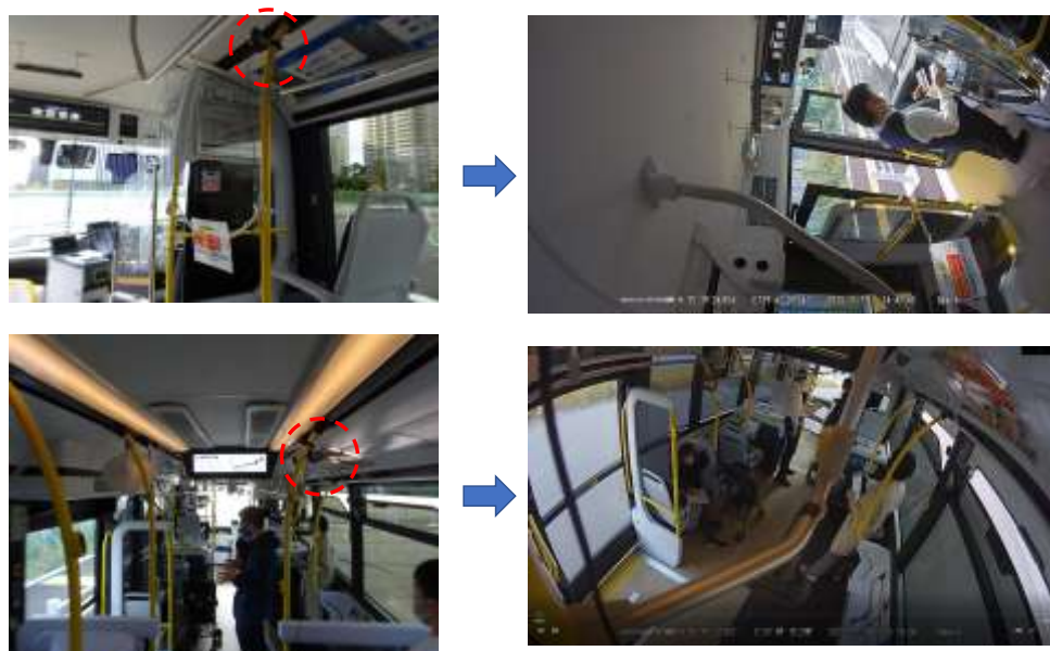
図 3-47 ドライブレコーダーの設置位置（左図赤破線）と画角（右図） （上段：前扉、下段：中扉）
