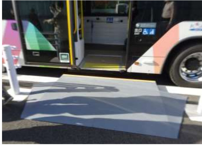
図 2-3 晴海 BRT ターミナルのサブバスに設置した可搬型乗降台
