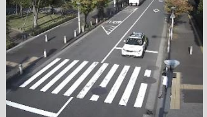
横断歩行者を検知し急減速(0.38G)、停止線を大きく踏み切って、歩行者に接近
