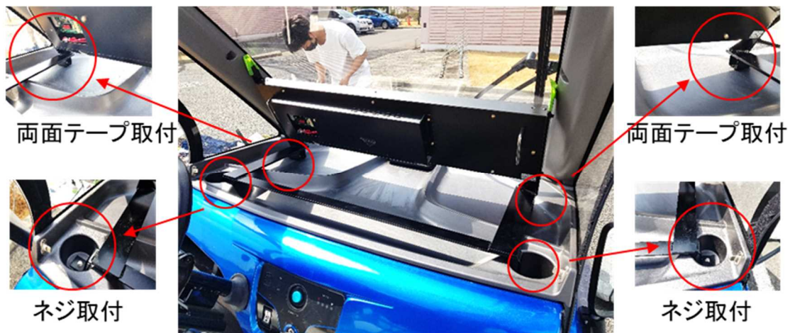
図 1-40 前方用 eHMI のダッシュボード上への取付状態
