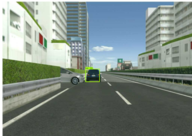
図 2-31 試作した HMI（非優先道路から出てきた自動車のシーン）
