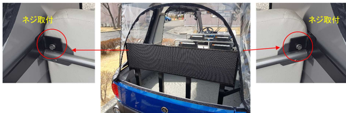
図 1-42 後方用 eHMI のリア荷室への取付状態
