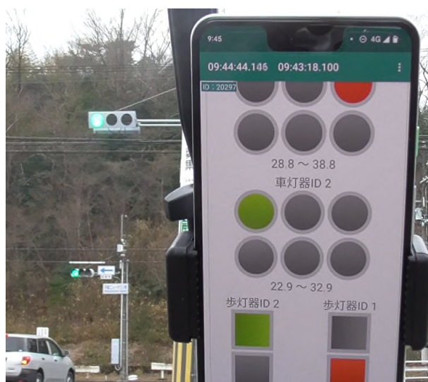
図 6.51 車両灯器の撮影映像の例（平城ニュータウン東）
