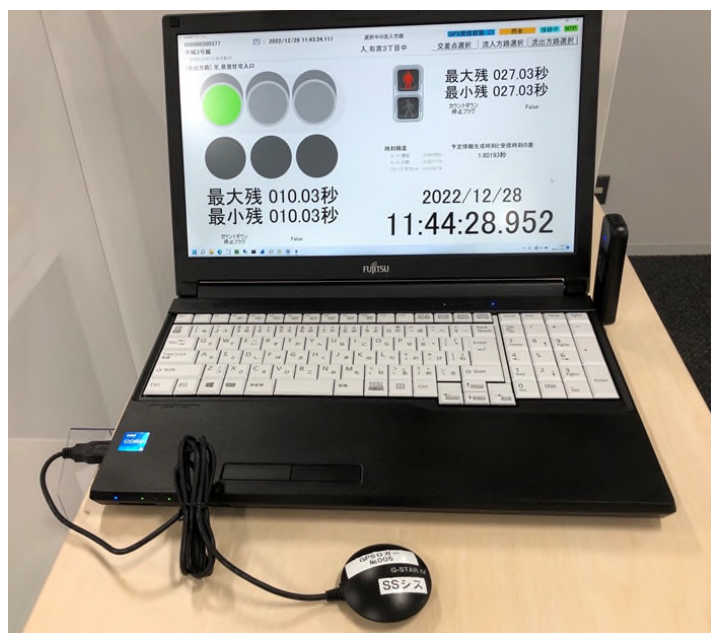
(b) 模擬車載機 (LTE ドングルはテーマ 6 からの借用品)
