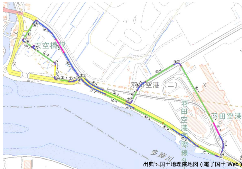
図 2-32 羽田空港地区 磁気マーカ設置数試算のための道路区分け
