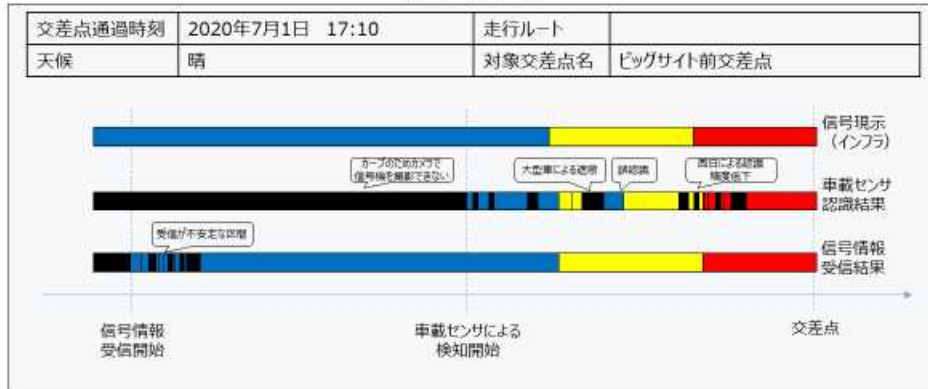
図 2-8 信号情報の有効性評価イメージ 車載カメラ認識結果と受信情報の比較方法
