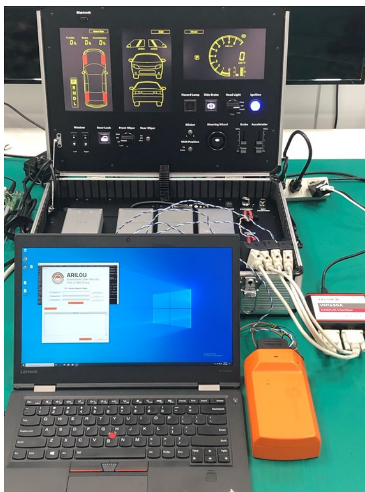
図 3-37 PASTA に機器を接続、動作させているところ
