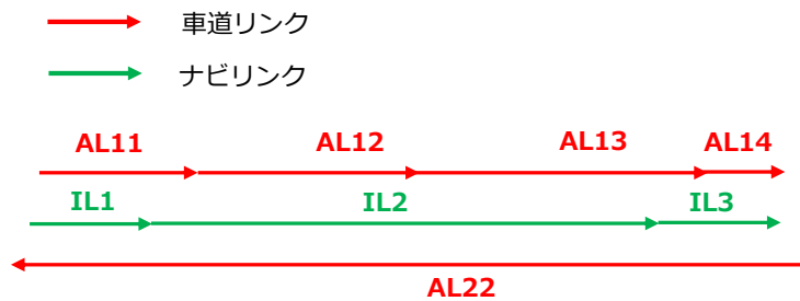
図 2-74 ナビリンク/車道リンクのサンプル
