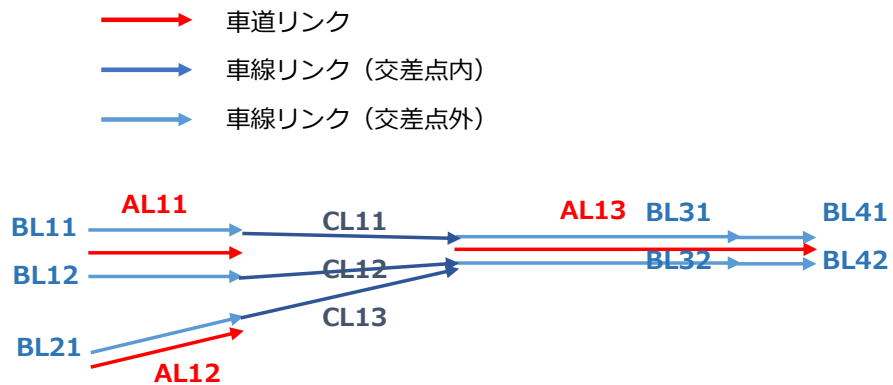
図 2-78 車道リンク/車線リンクの対応付けサンプル
