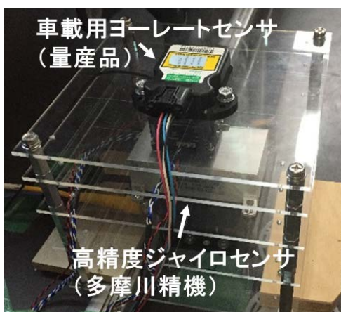
図 1-3. 2-2 慣性航法に用いるセンサ（車両重心位置に設置）
