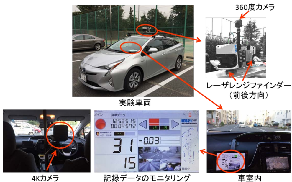
図 6-3 実験車両に搭載された各種計測機器
