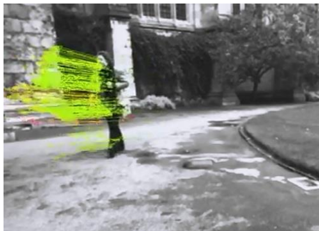
図 3.3.3-3 ステレオカメラによる動体予測
