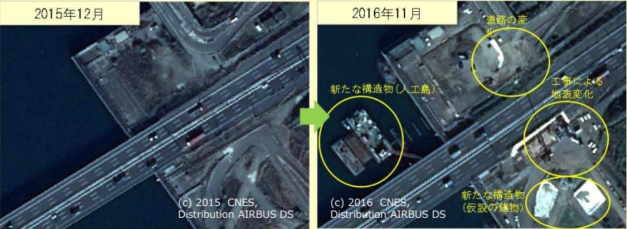
道路の変化や工事による構造物・地形の変化を検出可能
