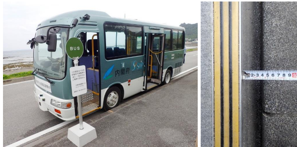
正着完了時の様子 (側方および仮想バス停、縁石との隙間)
