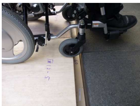
図 1.1-4 キャスタの向きが良いケース (間隙 60 mm+段差 18 mm)
