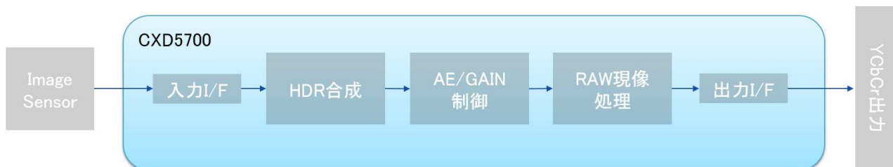
図 2.2.1-5 コンパニオンチップ CXD5700 の処理の流れ
