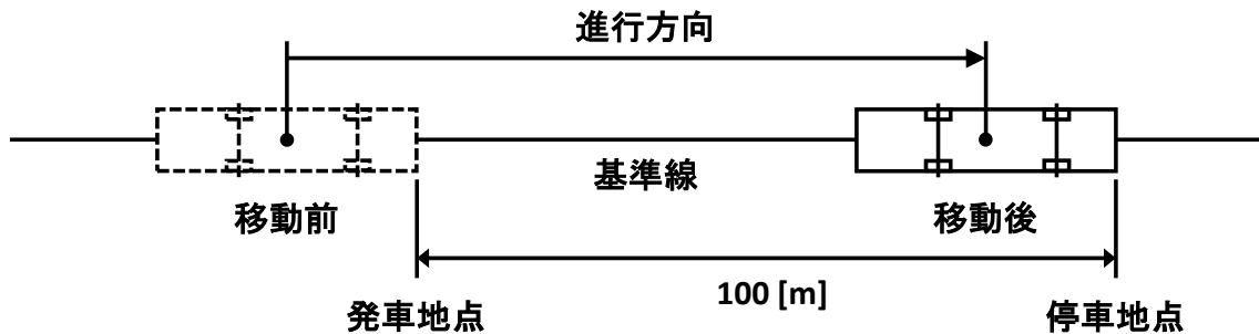
図 2.1.2.1-1 パイオニア製 GPS 学習型位置標定装置の距離精度検証実験の概要図
