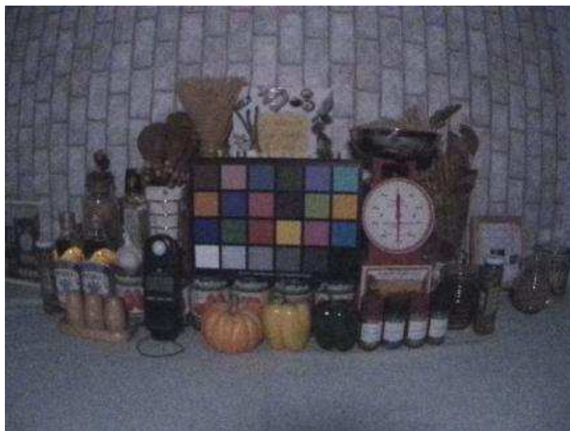
図 2. 2. 1-7 AEVB による照度 0.5 ルクスでの撮影例(暗室での撮影)
