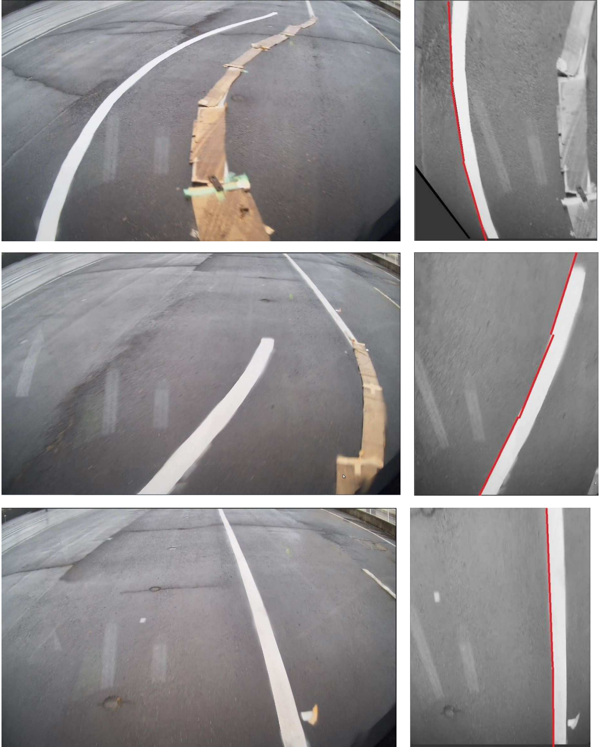
図 2.2.2-7 白線認識結果 1 (左：入力画像、右：IPM 画像上での認識結果)
