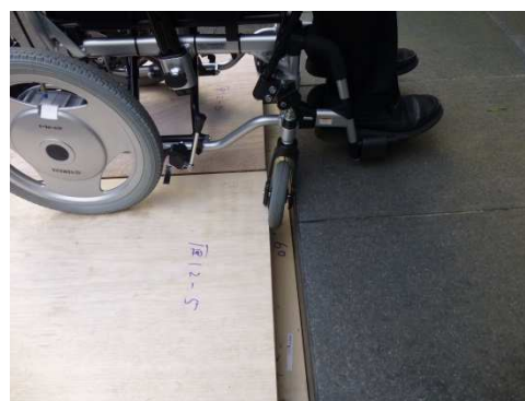
図 1.1-5 キャスタの向きが悪いケース (間隙 60 mm+段差 18 mm)
