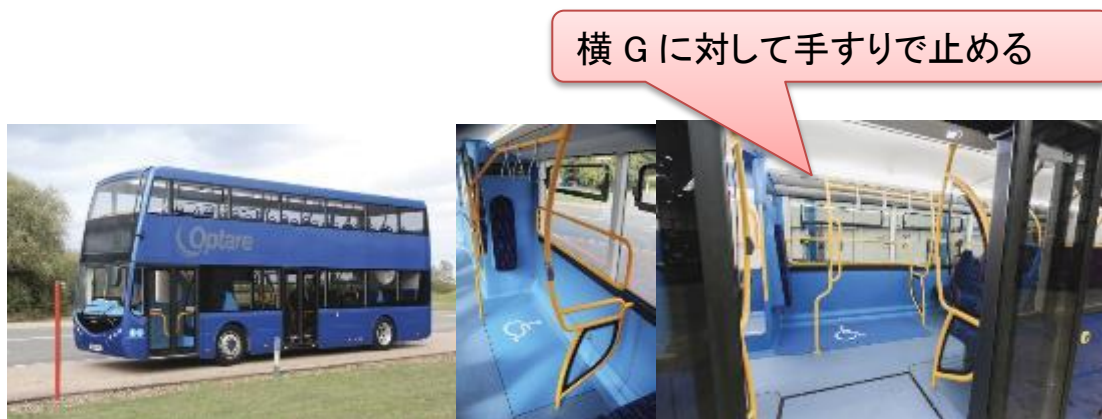
図表 3- 5 Optare 社 2 階建て車両の車椅子スペース
