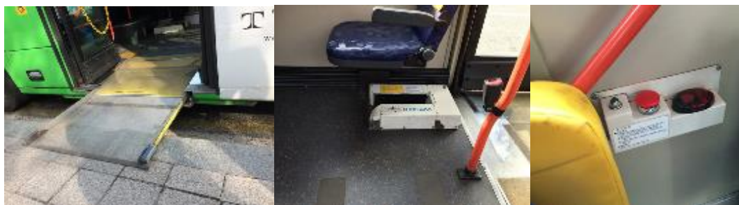
図表 3- 17 韓国バスの自動スロープと車輪固定装置
