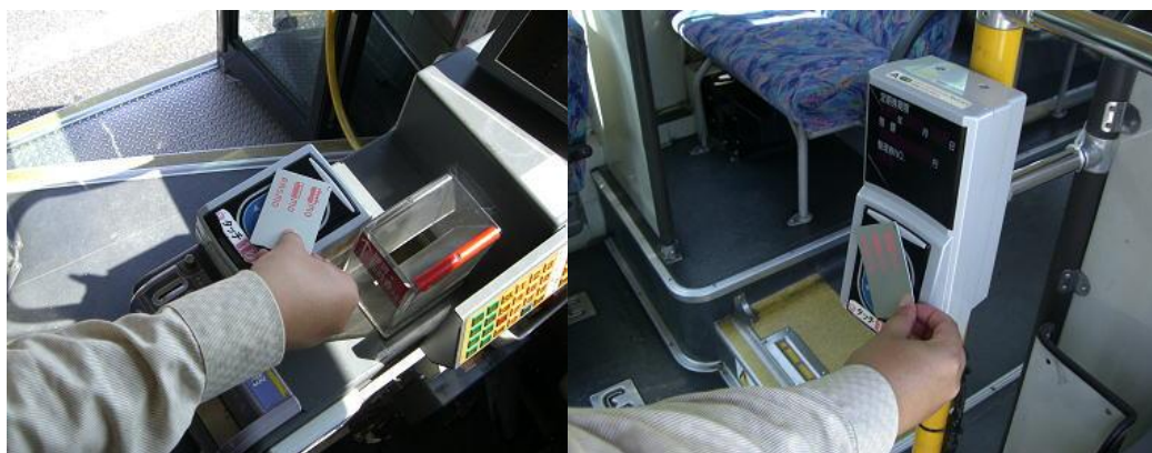
図表 2- 32 PASM0 のリーダー・ライター (左：前方乗降口、右：後方乗降口)
