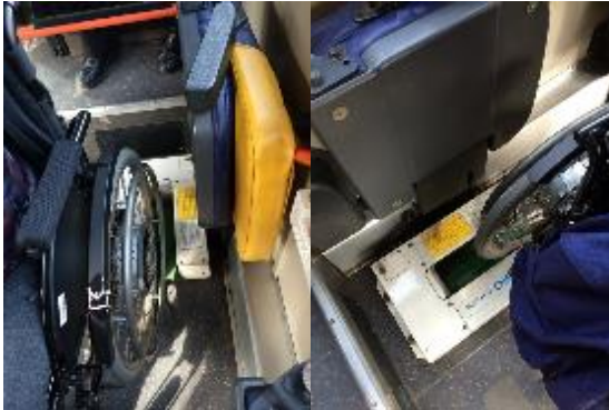
図表 3- 18 韓国バスの車輪固定装置と電動車椅子の干渉
