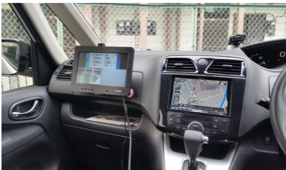
図 3. 1. 1-2 PC ロガーシステム表示部分
