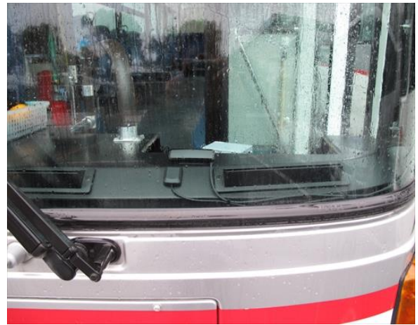
図 3.1.1-7 業務車用车載器取り付け状況例
