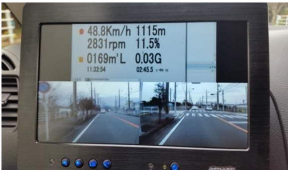
図 3. 1. 1-4 PC ロガーシステム計測画面例
