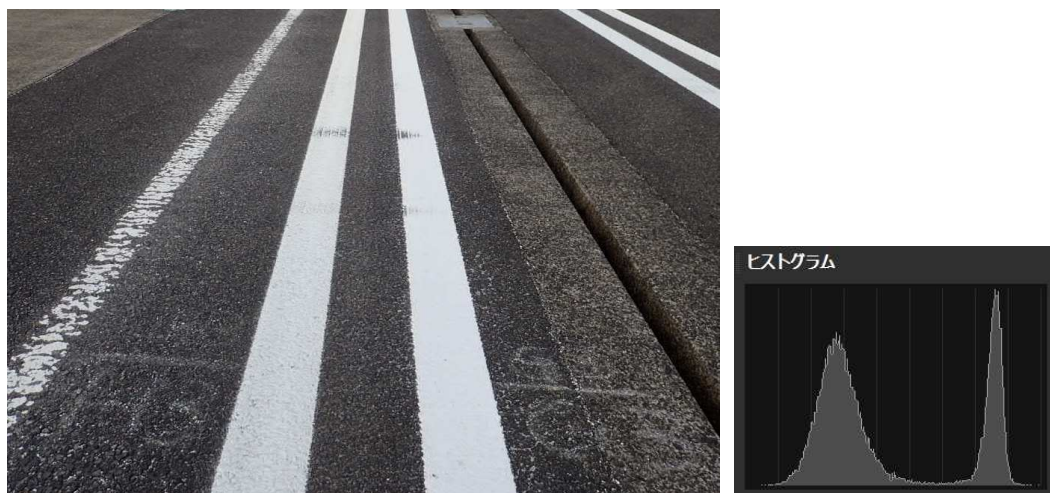
図 5.1.3-18 5 日目後の JIS K 5665 の 2 種 A 適合白線（左：H） （右図：JIS K 5665 の 2 種 A 適合白線とアスファルト部分の画像のヒストグラム）
