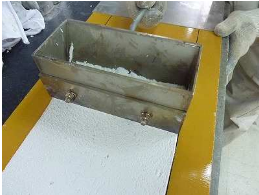
图 1.1.1-4 誘電率測定用試験板作製状況
