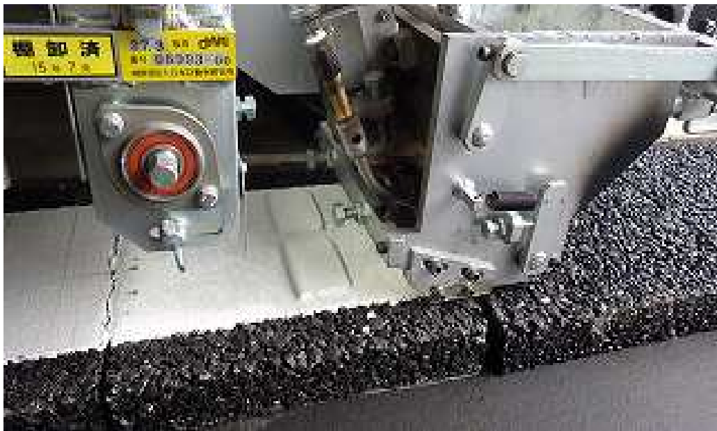
图 1.3.1-6 試驗片作製狀況拡大
