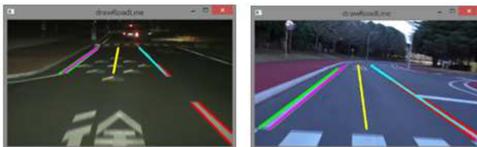
図 5.1.1-4 ビジョンセンサによる白線認識例
