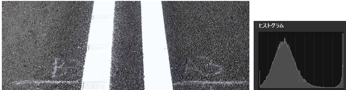
図 5.1.3-14 試験前のリブ白線の画像（左:B）JIS K 5665 の 3 種 1 号適合白線（右:A） （右図：JIS K 5665 の 3 種 1 号適合白線とアスファルト部分の画像のヒストグラム）
