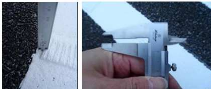
図 5.1.3-11 ノギスによる高さ計測の様子
