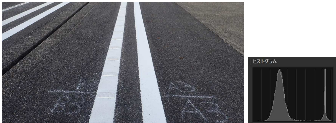
図 5.1.3-15 5 日目後のリブ白線の画像（左:B）JIS K 5665 の 3 種 1 号適合白線（右:A） （右図：JIS K 5665 の 3 種 1 号適合白線とアスファルト部分の画像のヒストグラム）
