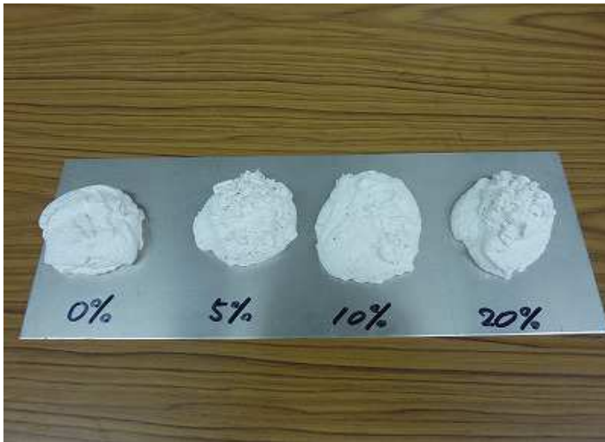
図 1.1.1-1 チタン酸バリウムを0、5、10、20%含有させた白線材料の流動性状況
