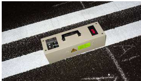
図 5.1.3-9 レーンマーク反射輝度測定器 (MX-7) による計測の様子
