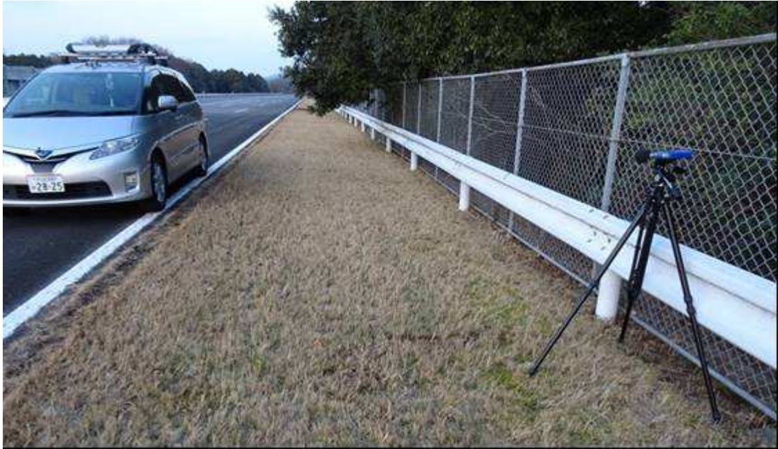
図 5.1.3-5 騒音計と設置状況
