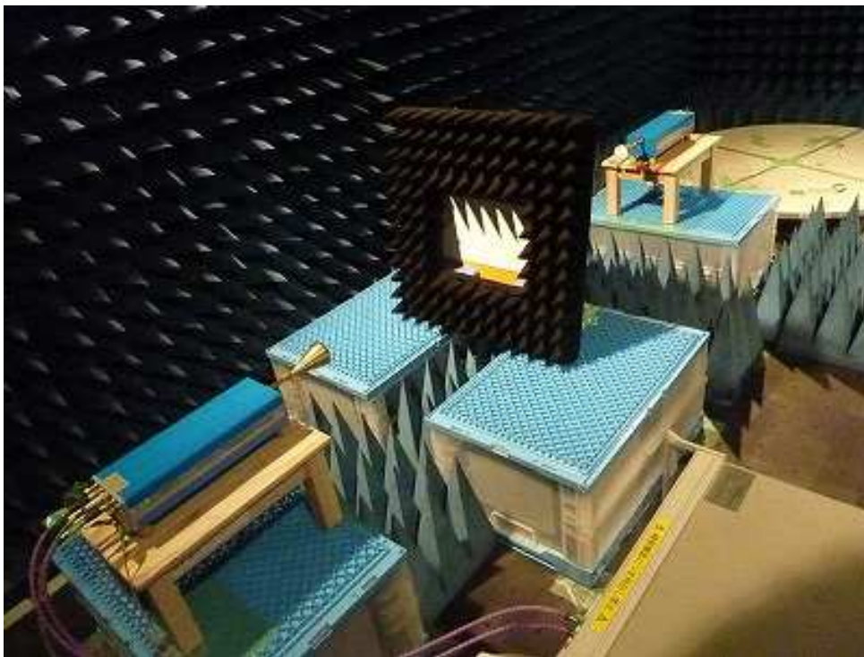
図 1.4.1-8 透過特性の測定状況
