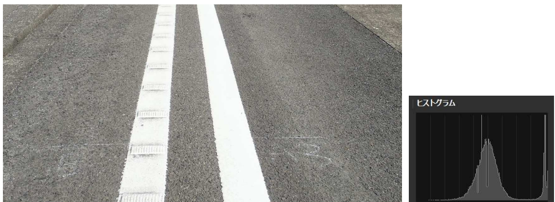
図 5.1.3-16 試験終了時のリブ白線の画像（左:B）JIS K 5665 の 3 種 1 号適合白線（右:A） （右図：JIS K 5665 の 3 種 1 号適合白線とアスファルト部分の画像のヒストグラム）
