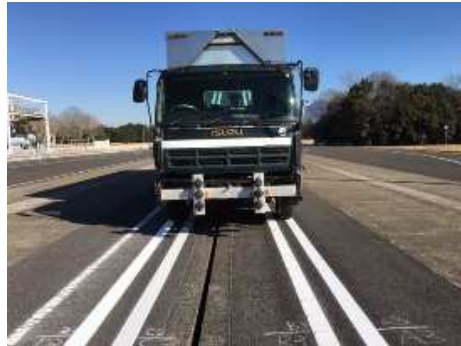
図 5.1.3-8 摩耗促進試験に使用した大型トラックと白線上走行の様子
