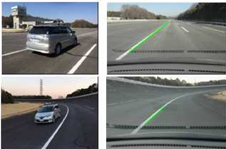
図 5.1.2-4 産総研試走路での車線追従の様子（上段：直線、下段：180R 曲線）
