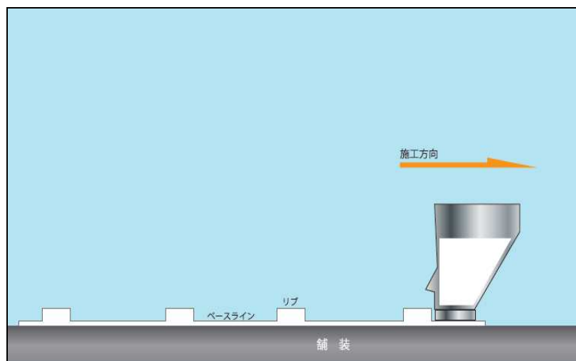
図 1.2.1-1 リブ式標示施工イメージ
