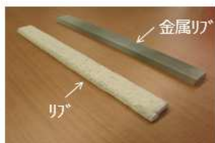
図 4.1.1-2 1個リブと同じ形状の金属リブ
