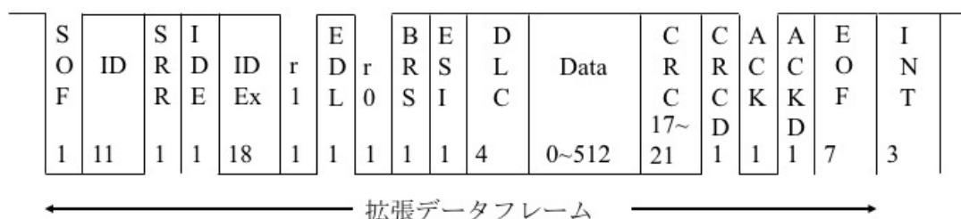
図 3.2c.1-12 CAN-FD データフレーム（拡張フォーマット）の各フィールド
