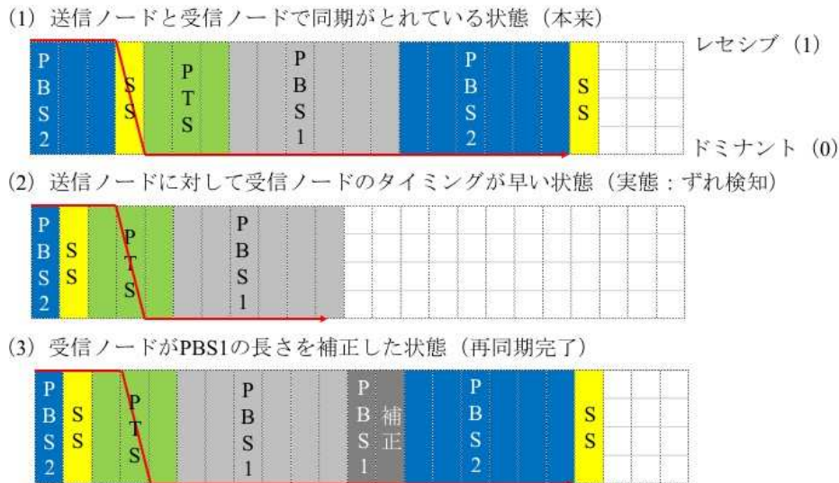
図 3.2c.3-7 受信ノードの再同期手順：受信ノードのエッジが TSEG1 にある場合 （赤実線は CAN バスに流れた電気信号を表す）
