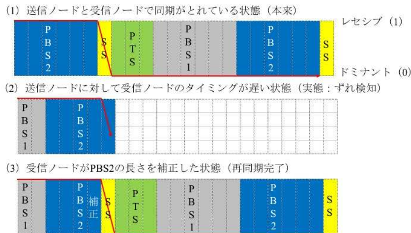
図 3.2c.3-8 受信ノードの再同期手順：受信ノードのエッジが TSEG2 にある場合 （赤実線：CAN バスに流れた電気信号を表す）
