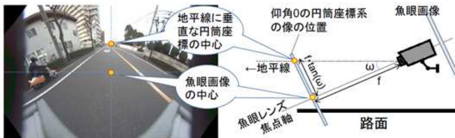
図 3.2.2-4 円筒変換の地平線位置算出原理
