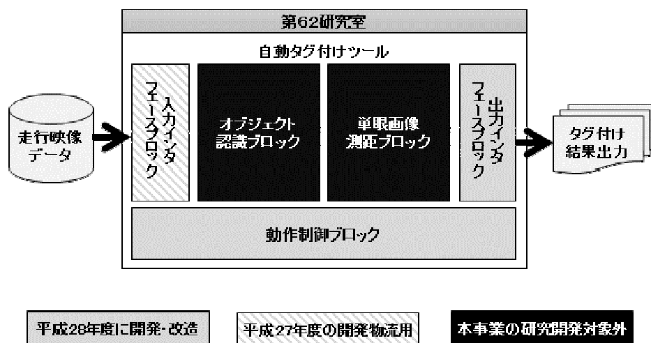
図 2.1.2-1 自動タグ付けツールのソフトウェア機能ブロック構成
