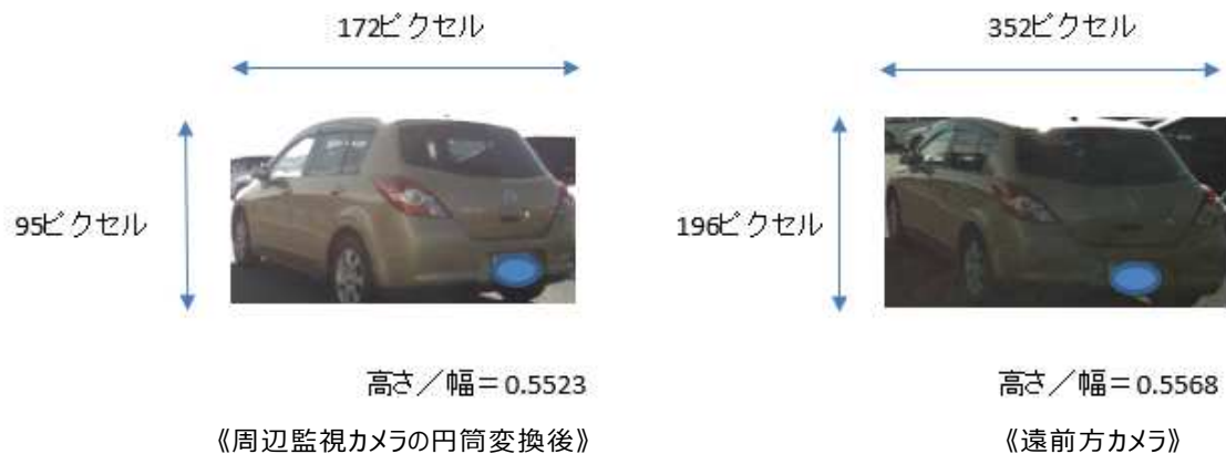
図 3.2.2-8 周辺監視カメラと前遠方カメラの対象物矩形映像比較（サンプル 2）
