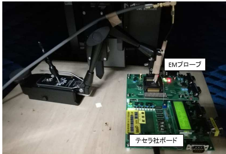
図 3.2e.3-6 電磁ボックス内のボードと EM プローブ
