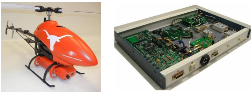
図 7.2.2-1 UAV と GPS spoofer [34]
