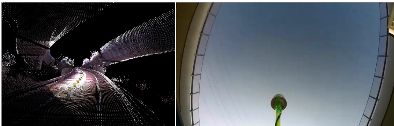
図 4.2.3-24 MMS 点群データ・上空写真（両側遮蔽）
