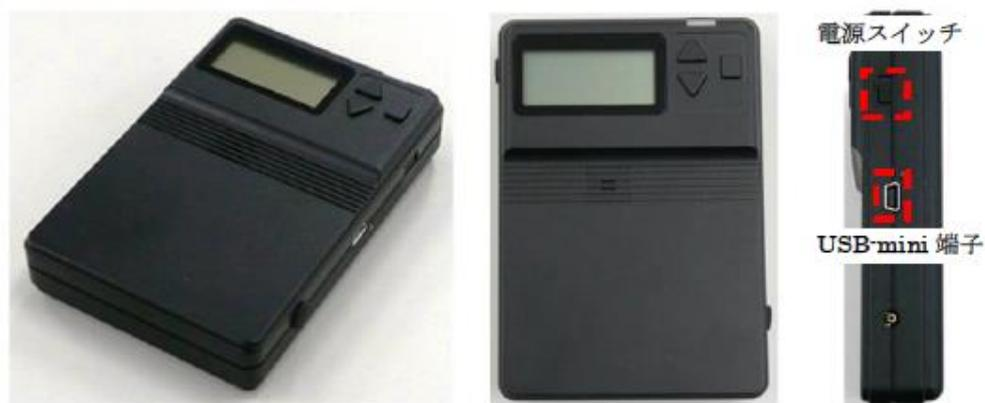
図 2.3-4 700MHz 帯通信端末 外観写真
