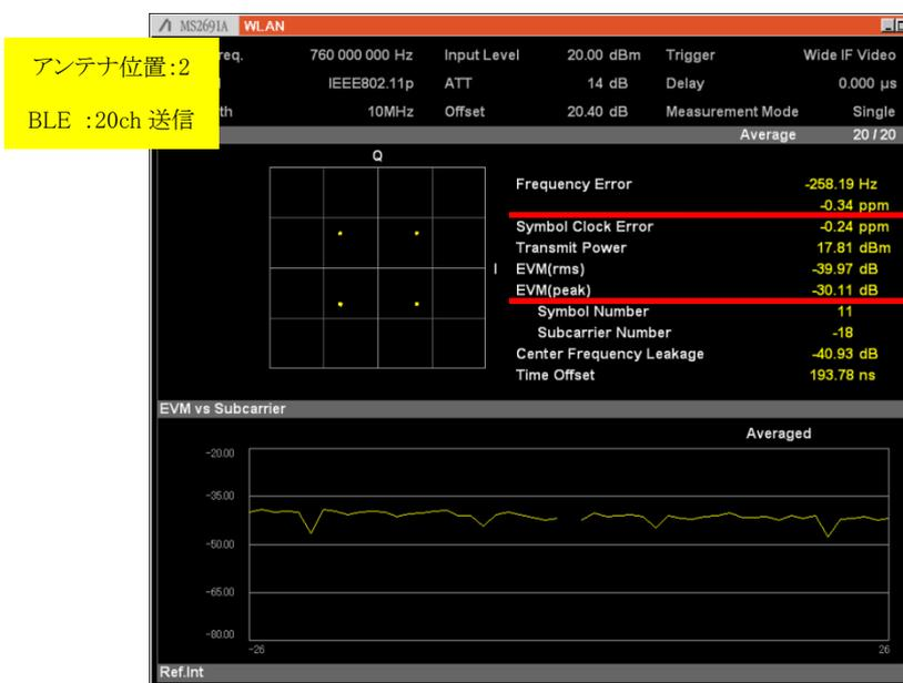
図 3.7-16 アンテナ位置:2 20ch 送信時の Frequency Error & EVM 特性
