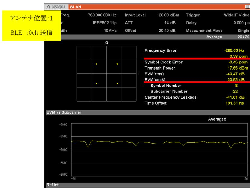
図 3.7-12 アンテナ位置:1 0ch 送信時の Frequency Error & EVM 特性
