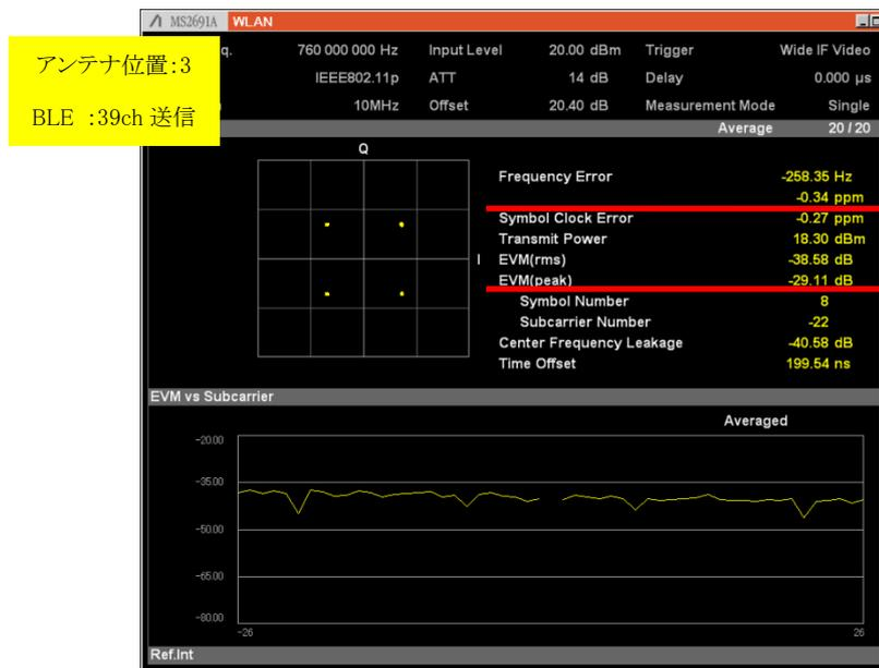
図 3.7-20 アンテナ位置:3 39ch 送信時の Frequency Error & EVM 特性
