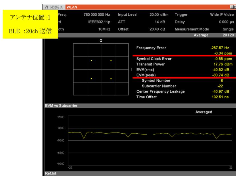
図 3.7-13 アンテナ位置:1 20ch 送信時の Frequency Error & EVM 特性
