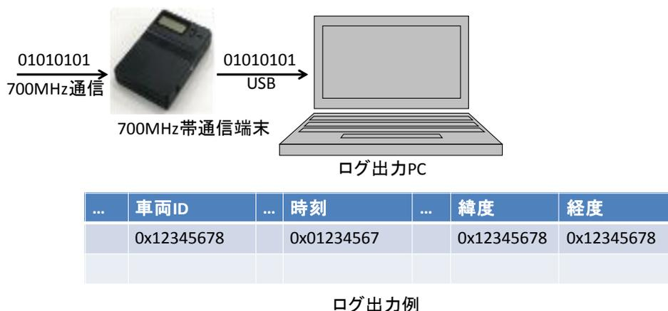
図 3.1-1 700MHz帯通信端末 ログ出力方法
