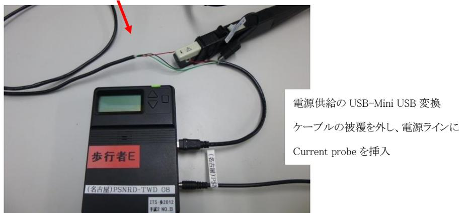
図 3.8-1 700MHz 帯通信端末の電流測定環境
