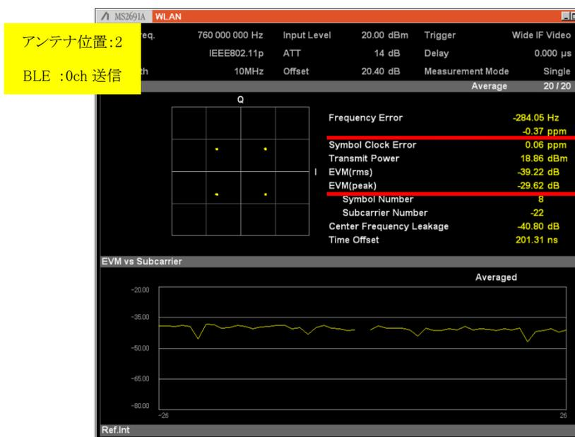
図 3.7-15 アンテナ位置:2 0ch 送信時の Frequency Error & EVM 特性
