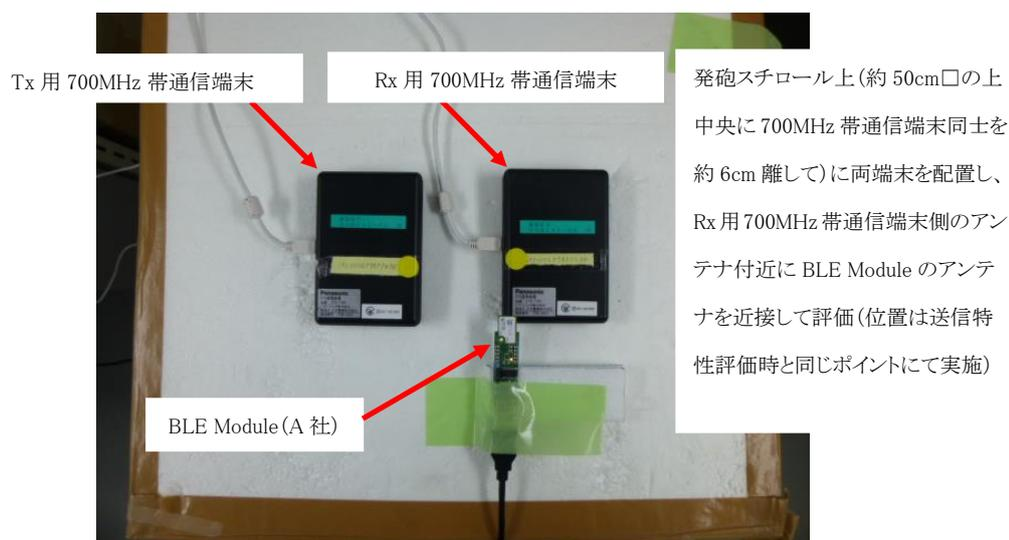
図 3.7-21 PER 測定時の 700MHz 帯通信端末配置図
