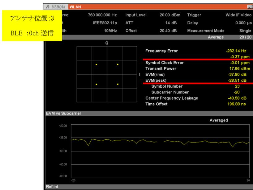
図 3.7-18 アンテナ位置:3 0ch 送信時の Frequency Error & EVM 特性
