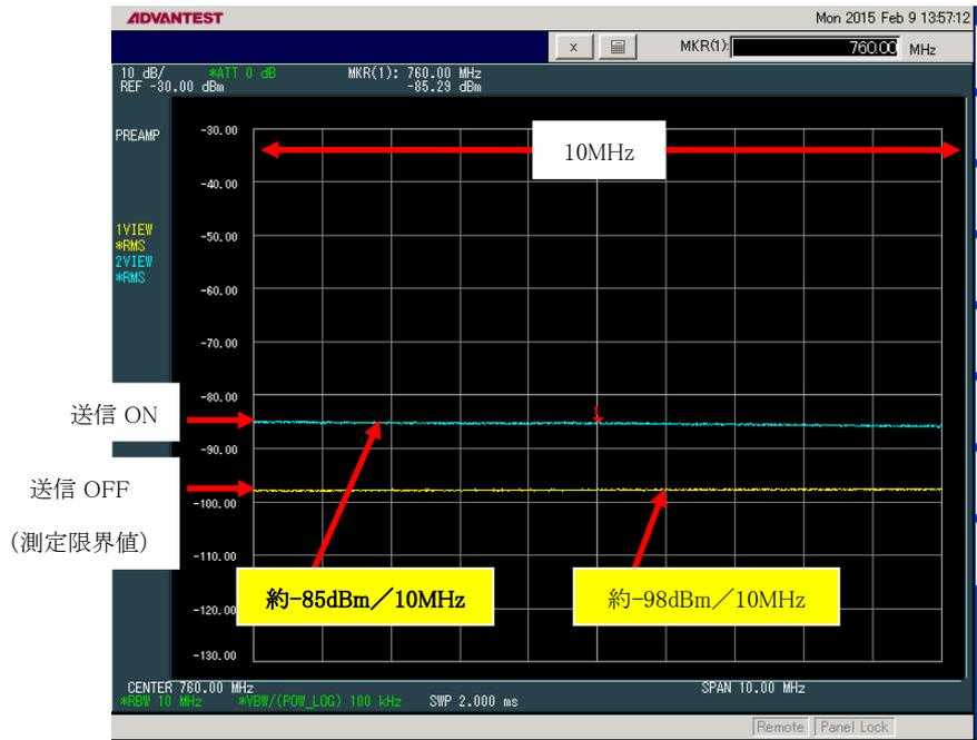
図 3.6-3 A 社 BLE Module 送信時の 760MHz 帯雑音電力
