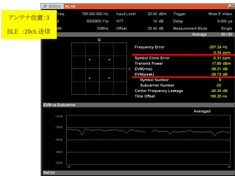
図 3.7-19 アンテナ位置:3 20ch 送信時の Frequency Error & EVM 特性
