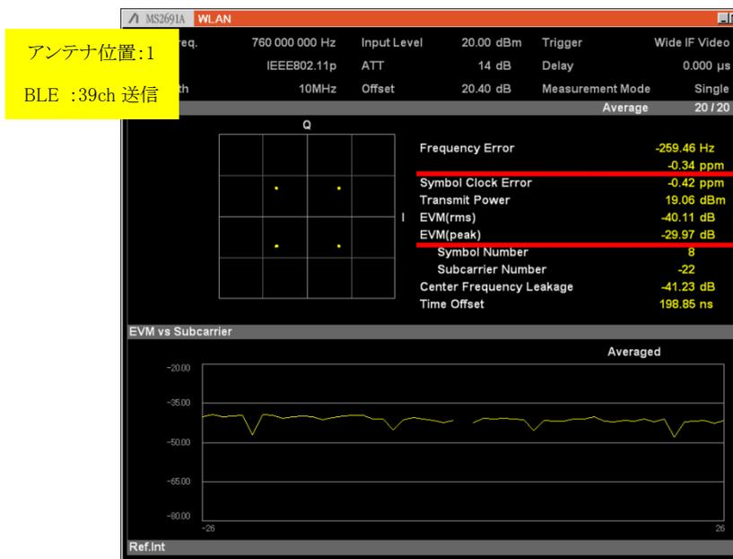
図 3.7-14 アンテナ位置:1 39ch 送信時の Frequency Error & EVM 特性
