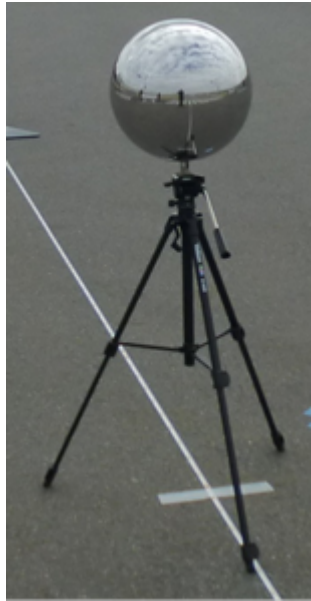
図 5.1.2-60 伝搬実験に使用したターゲット外観 (球体リフレクタ)
