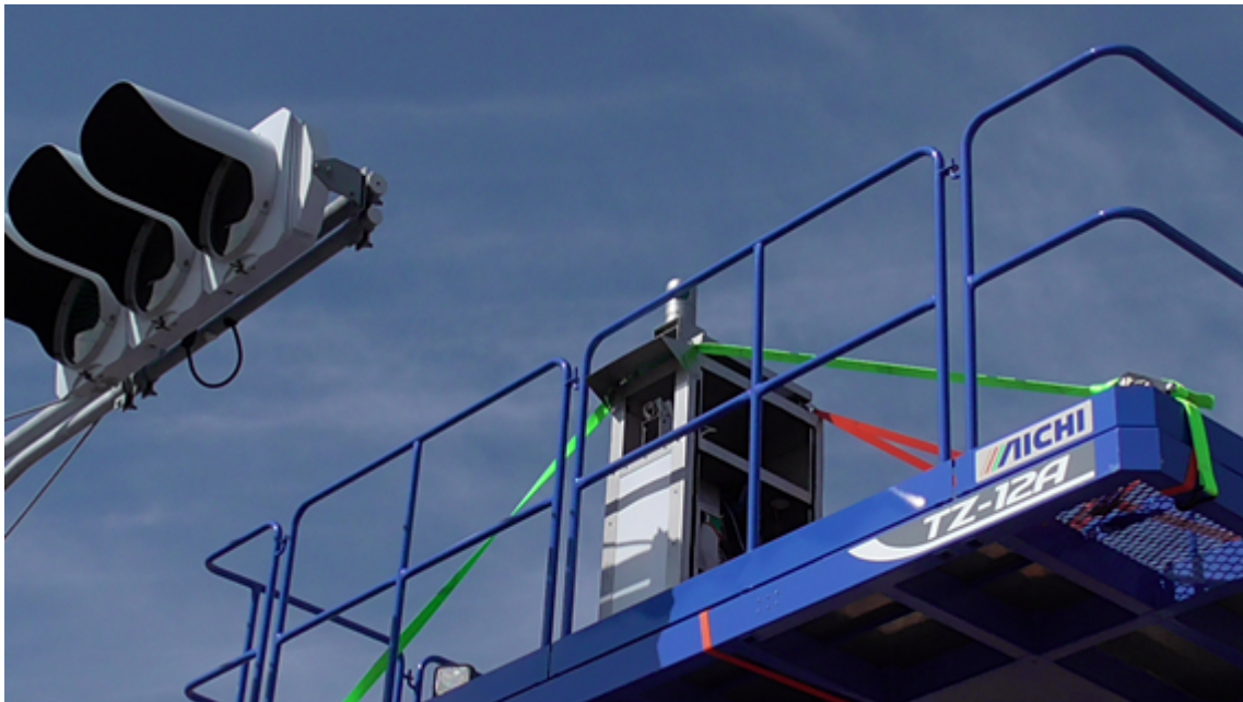
図 5.1.3-1 3種類のセンサーを設置した固定治具
