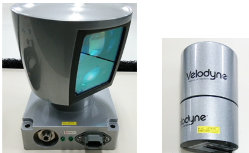
図 5.1.3-20 測位リファレンス用のレーザーレーダー (左：長距離用、右：近距離用)
