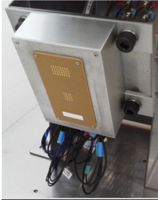
図 5.1.2-23 RF 基板等を格納した状態のレーダーモジュール外観
