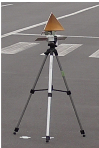
図 5.1.2-59 伝搬実験に使用したターゲット外観 (コーナーリフレクタ)
