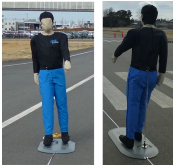
図 5.1.2-61 伝搬実験に使用したターゲット外観 (歩行者ダミー)
