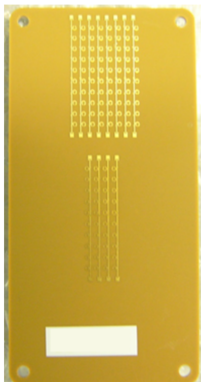
図 5.1.2-26 RF 基板外観 (20m～40m 用平面アレイアンテナの放射面)
