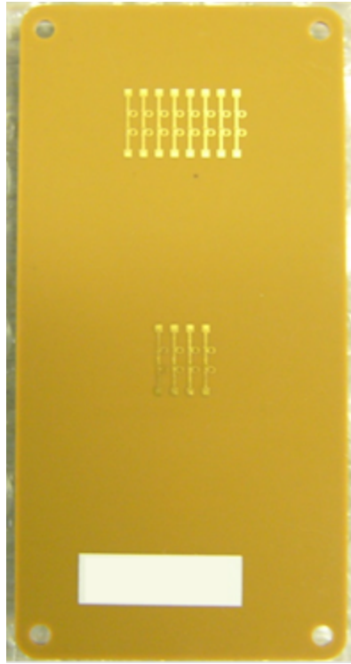
図 5.1.2-27 RF 基板外観 (5m~20m 用平面アレイアンテナの放射面)
