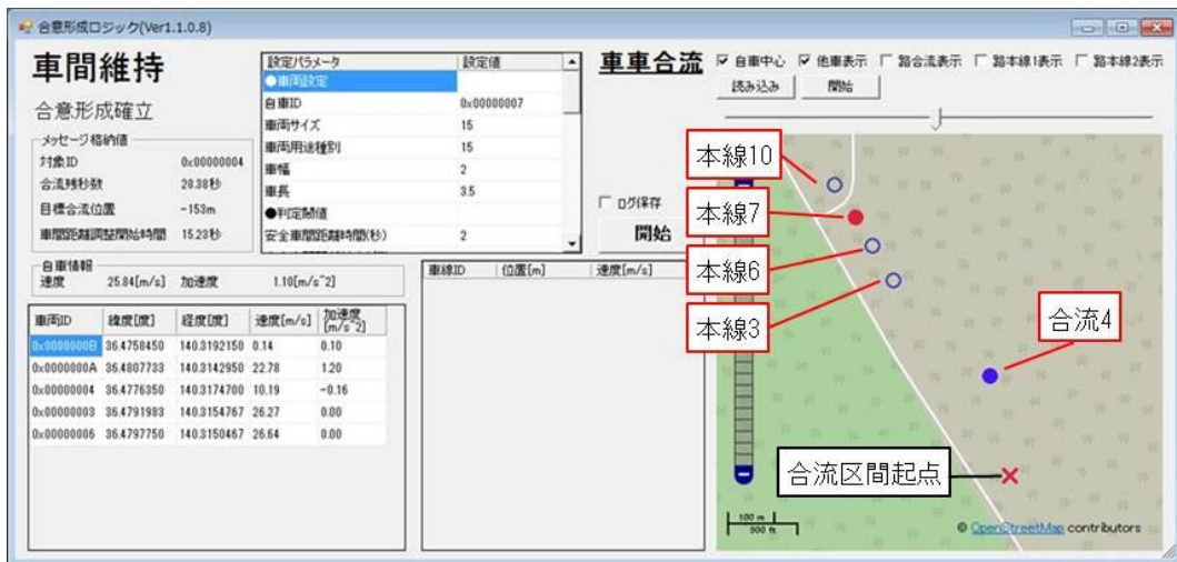
図 5.4.4-76 車両状態と位置関係（本線車両 7：合意形成確立時）
