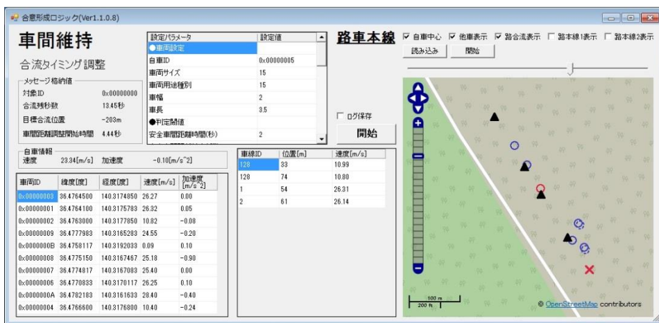
図 5.4.2-29 画面例 3 : 路車間通信活用実験(合流車両検知)-本線車両-車間維持発生時
