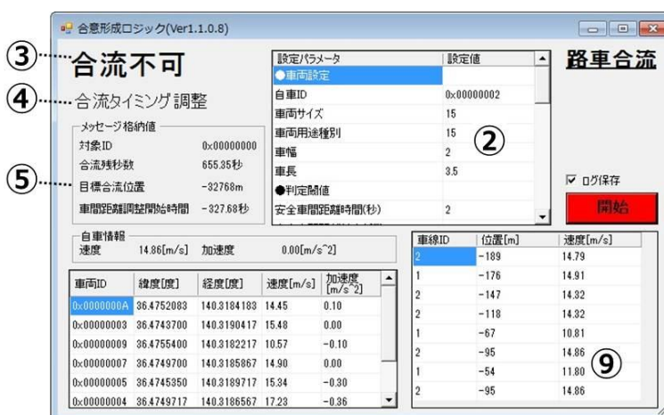
図 5.4.6-9 路車合流モード画面：合流タイミン調整（合流不可）
