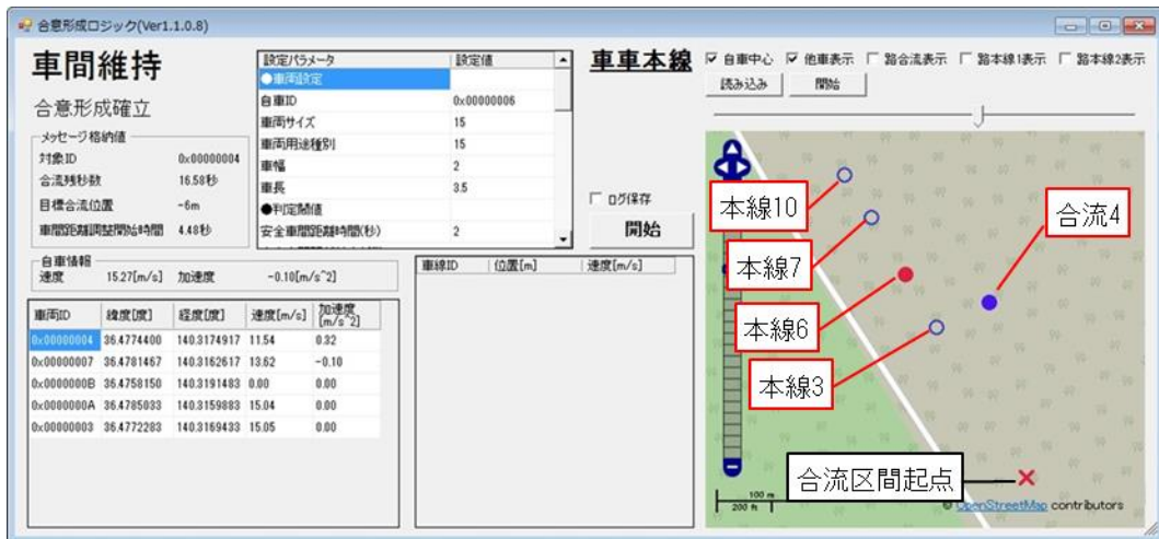
図 5.4.4-36 車両状態と位置関係（本線車両 6：合意形成確立時）
