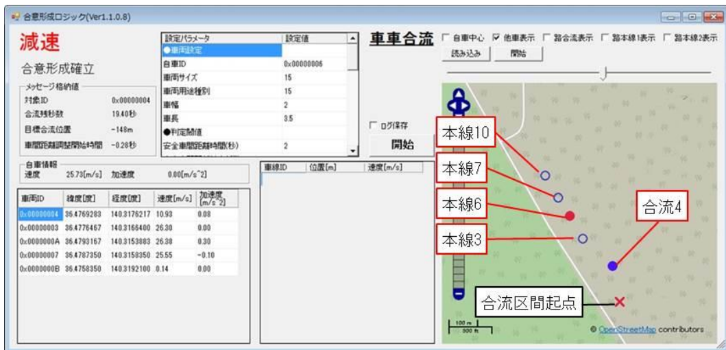
図 5.4.4-77 車両状態と位置関係（本線車両 6：合意形成確立時）
