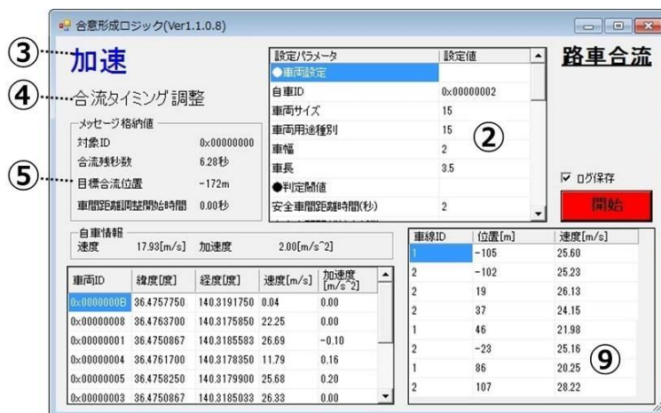
図 5.4.6-8 路車合流モード画面：合流タイミン調整（加速指示）
