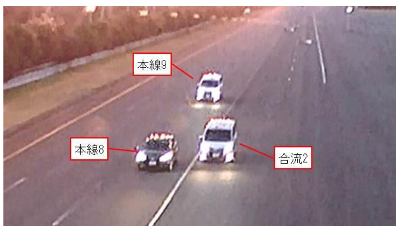
図 5.4.6-46 下流側からの俯瞰映像（合流車両 2 の合流区間起点通過 12 秒後）
