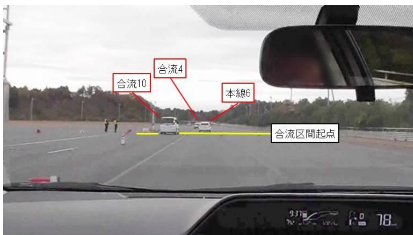
図 5.4.4-97 前方映像（本線車両 7：合流車両 10 の合流区間起点到達時）
