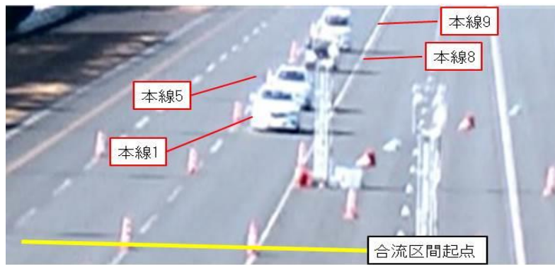
図 5.4.5-44 下流側からの俯瞰映像（本線車両 8 の合流区間起点上流 200m 地点到達時）
