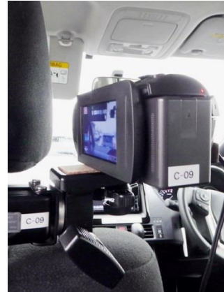
図 5.4.2-24 車窓撮影アングルと機材設置状況：車両 9（本線路第 1 車線走行）
