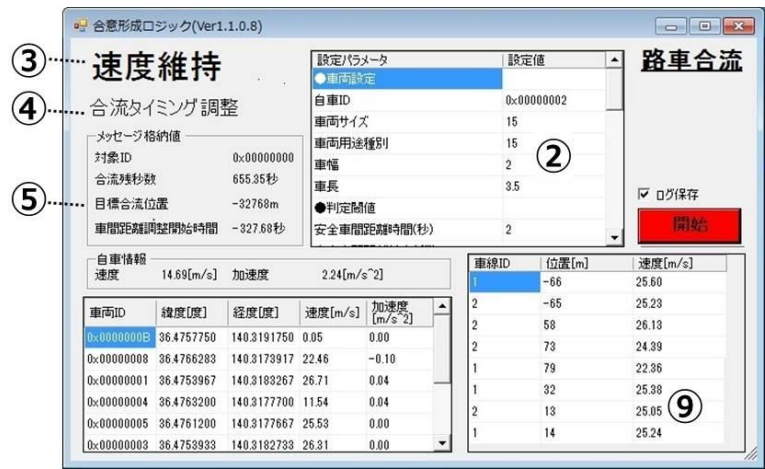
図 5.4.6-7 路車合流モード画面：合流タイミング調整（速度維持指示）
