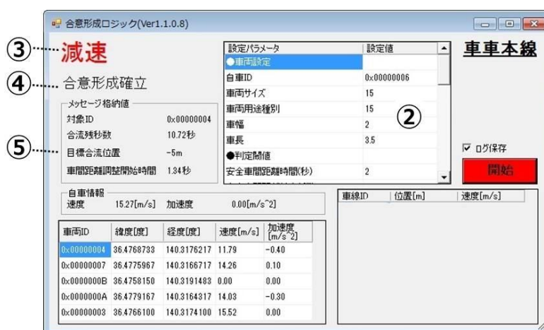
図 5.4.4-12 車車本線モード画面：合意形成確立（減速指示）
