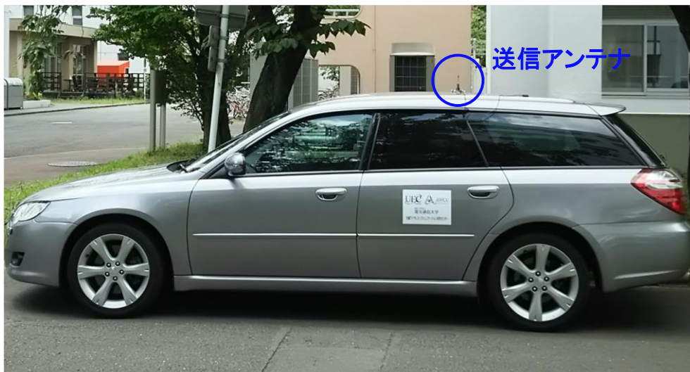
図 4.2.2-2 実験車両 (車載器の送信アンテナを装着)
