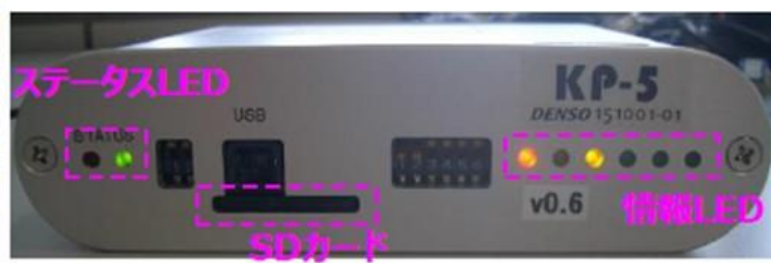
図4.1.2-18 700MHz 送受信開始状態(車載機本体)
