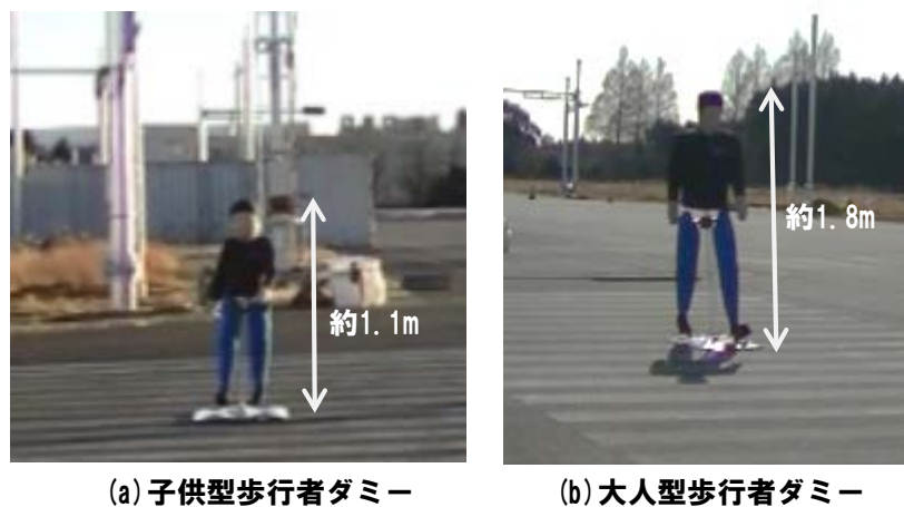
図 5.1.3.1.2-6 駆動型歩行者ダミーの外観とおおよその大きさ
