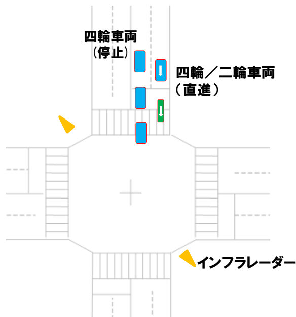
図 5.1.3.2.2-2 “①右折車両と直進車両の衝突事故”シーン検出性能検証向けの 実験データ取得シナリオ概要
