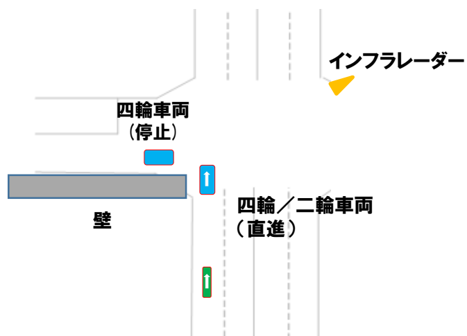
図 5.1.3.2.2-14 “③優先道路進入時の出会い頭事故”シーン検出性能 検証向けの実験データ取得シナリオ概要
