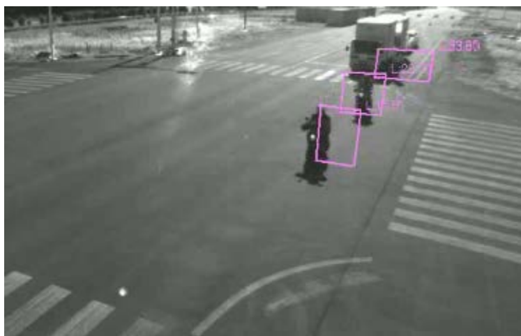
図 5.1.3.2.2-11 “②左折車両による二輪車巻き込み事故”シーンのインフラレーダー検出状況(カメラ画像との重畳図)
