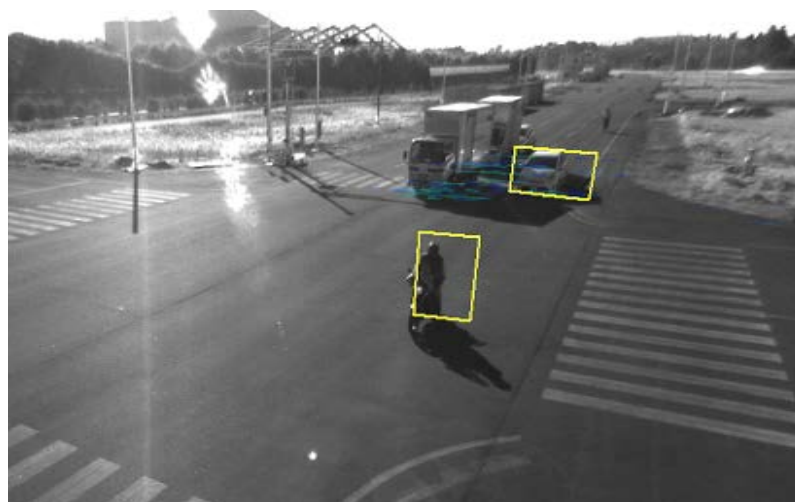
図 5.1.3.2.2-5 “①右折車両と直進車両の衝突事故”シーンの インフラレーダー検出状況(カメラ画像との重畳図)
