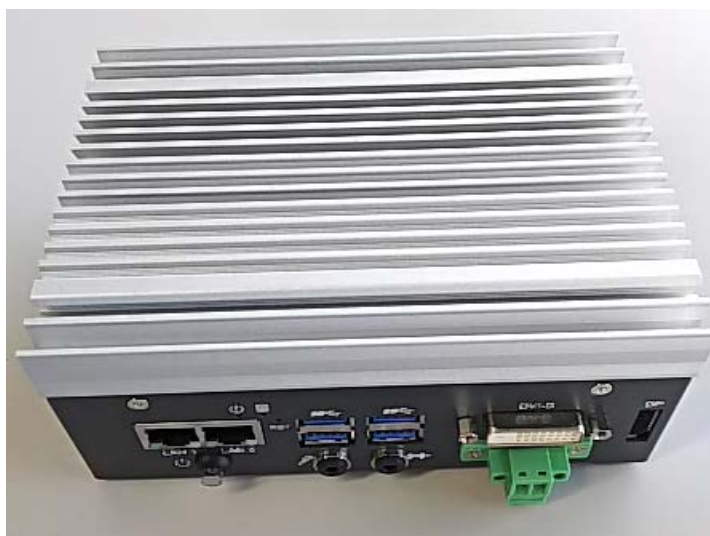
図 5.1.3.2.1-2 センサー統合処理装置のデバイス制御機外観
