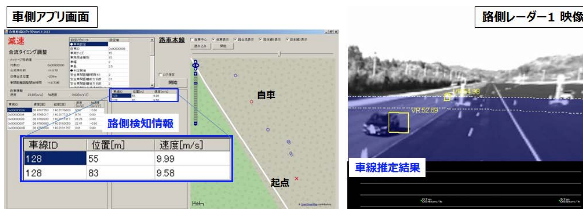
図 4.2-9 車側における路側検知情報の活用例/路側レーダーの検知データ例
