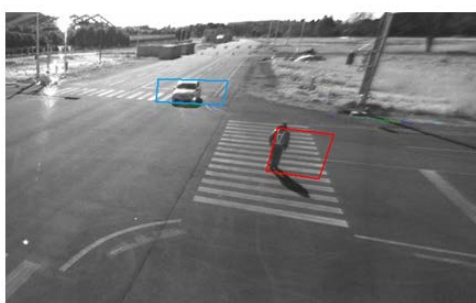
図 4.2-1 SVM を用いた四輪車・二輪車判別アルゴリズムの検証データ例 (青枠：四輪車、緑枠：二輪車、赤枠：歩行者)
