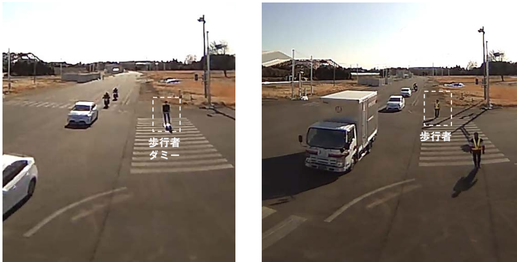
図 5.1.3.2.2-21 “④右左折車両による横断歩行者との衝突事故”シーンの 実験データ取得時の様子(左：歩行者ダミー設置時、右：歩行者検出実験時)
