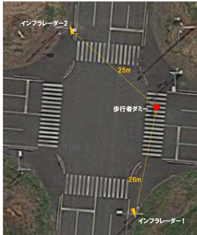
図 5.1.3.2.2-25 歩行者ダミーの設置位置とインフラレーダー1、インフラレーダー2の位置関係
