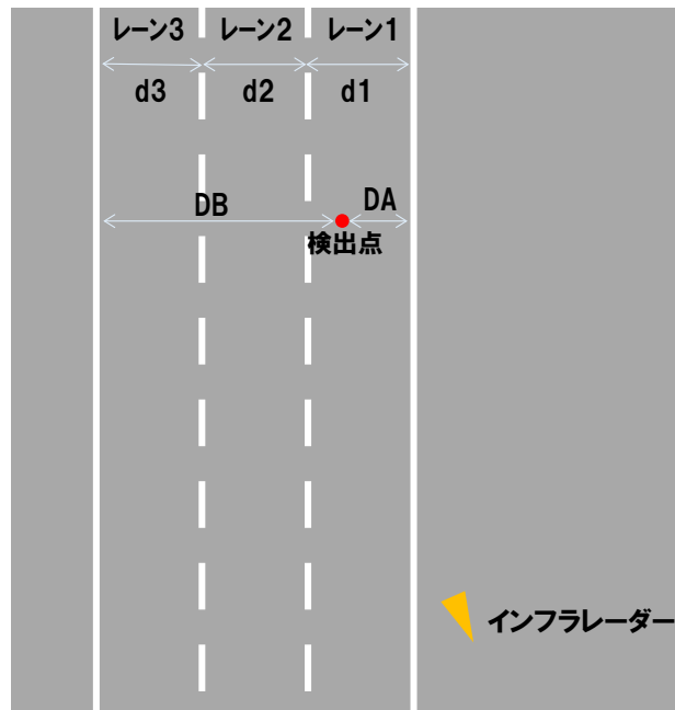
図 5.4.2.1.2-4 路車連携機能の検証実験に向けたインフラレーダーの車線判定処理説明補足図
