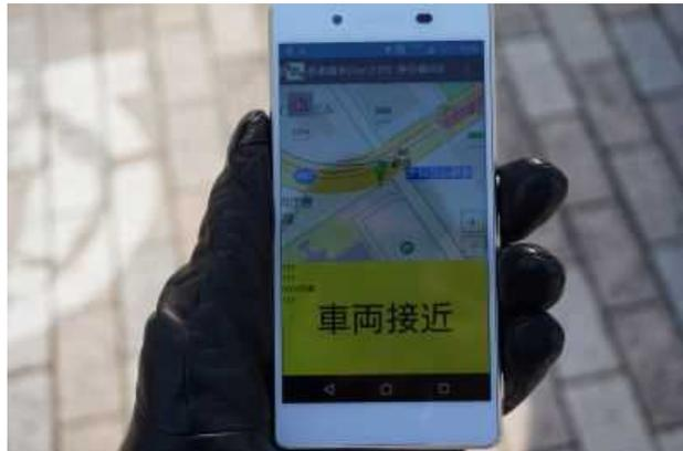
図 8-2-69 実験参加者が保持した歩車間通信システムの端末(スマートフォン)
