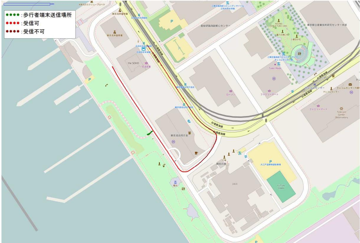
図 9-2-121 【歩側・交差点】700MHz 帯通信の受信状況 試番 20
