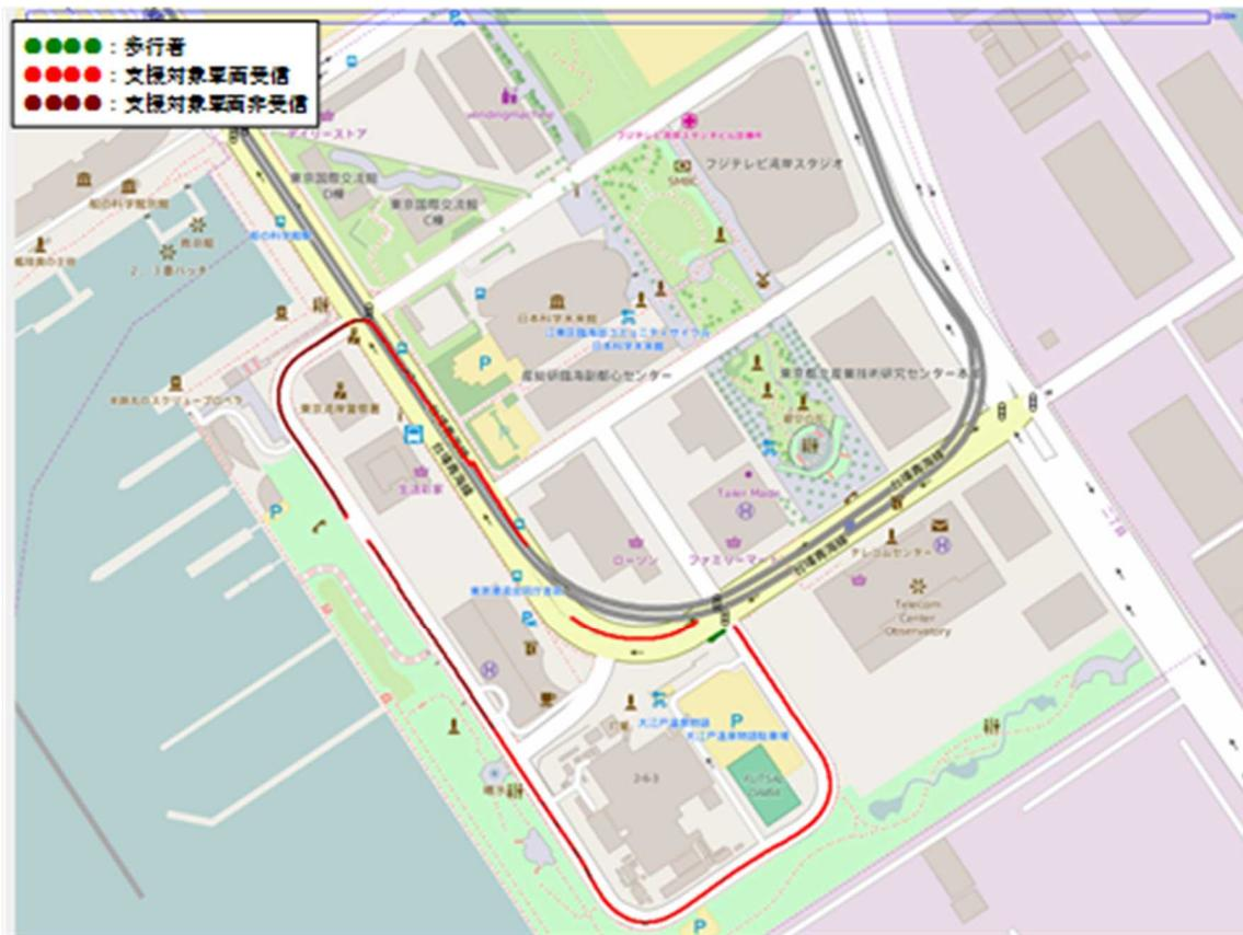
図 9-1-21 試番 12 車載器、専用歩行者端末間の送受信状況
