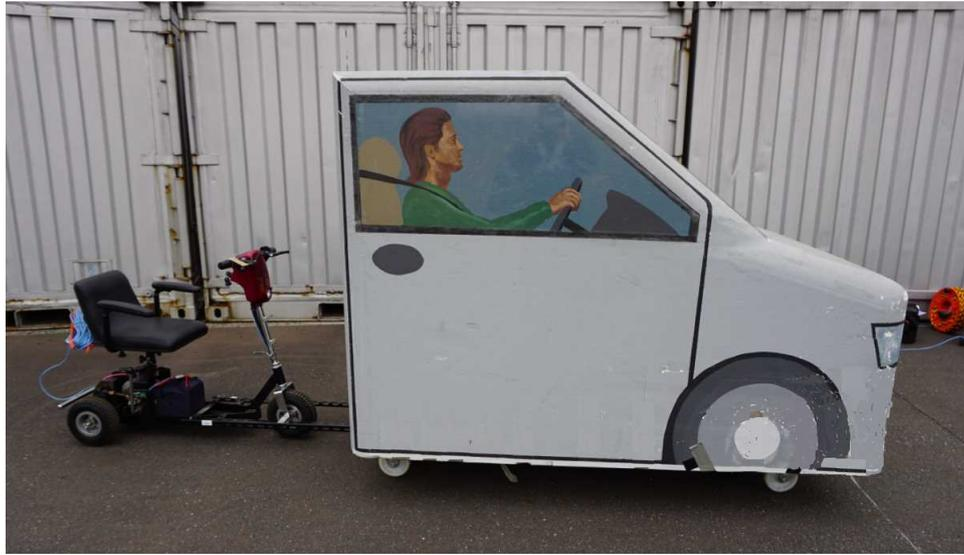
図 7-7 実験用ダミー車両
