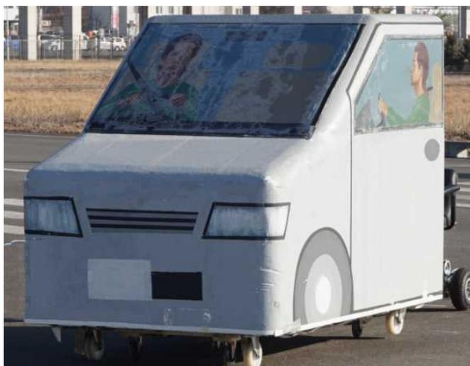
図 7-3 ダミー車両（車両部）
