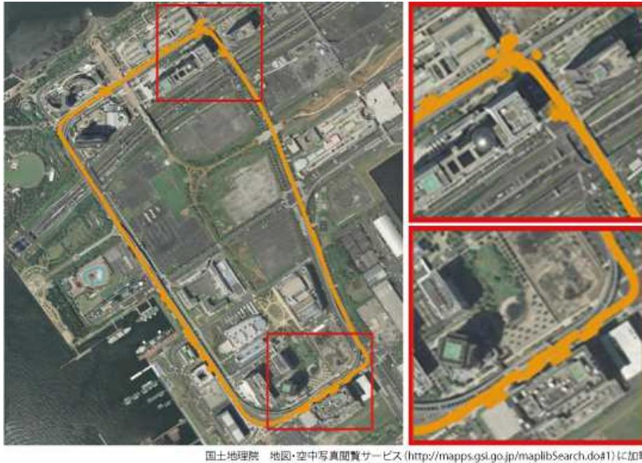
図 12-9 GNSS-RTK 時の走行軌跡 (IMU は使用しない)
