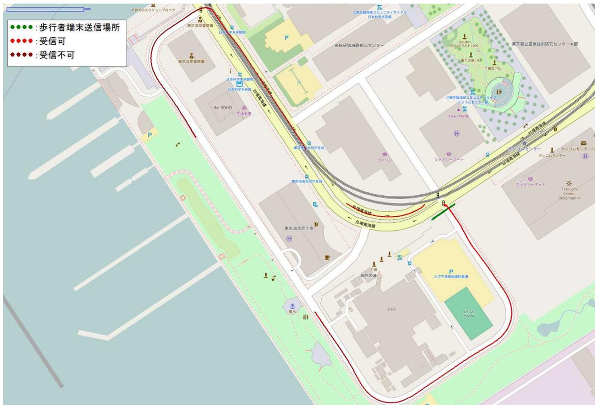
図 9-2-111 【車側・交差点】700MHz 帯通信の受信状況 試番 15
