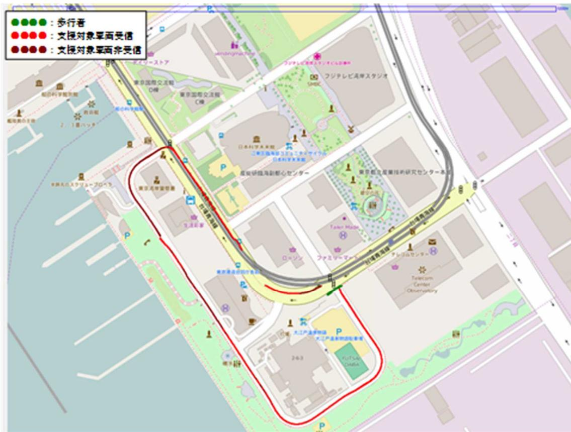
図 9-1-19 試番 11 車載器、専用歩行者端末間の送受信状況
