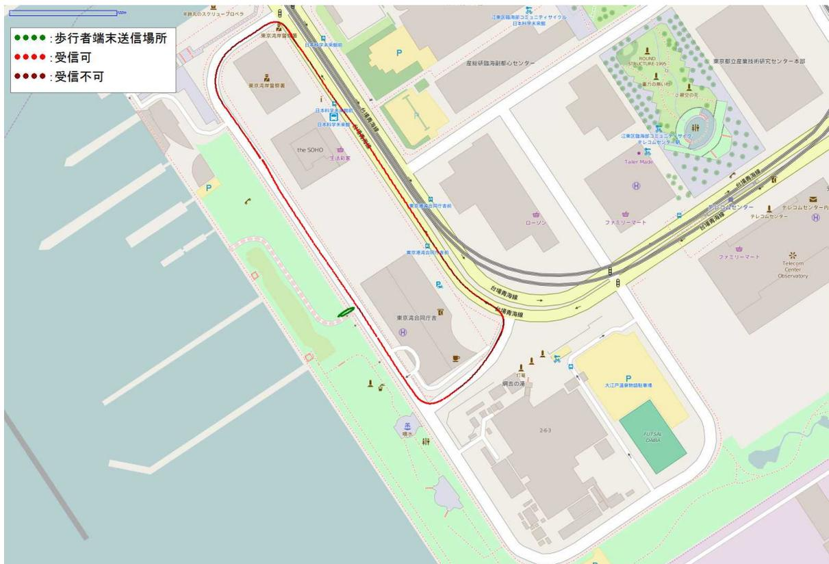
図 9-2-117 【歩側・交差点】700MHz 帯通信の受信状況 試番 18
