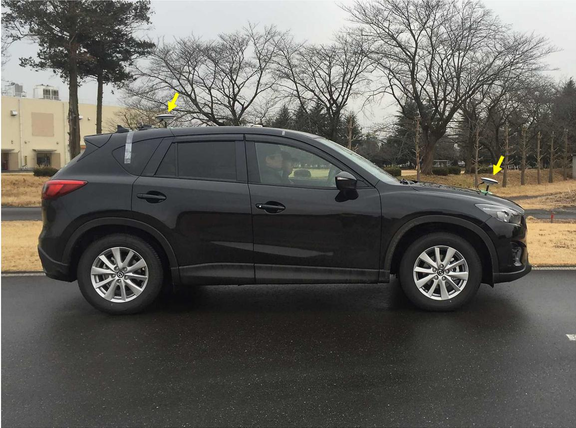
図 12-5 GNSS アンテナ設置写真
