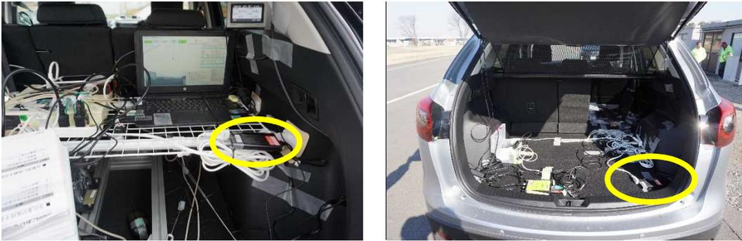
図 6-4 DC/AC インバータによる電源供給
