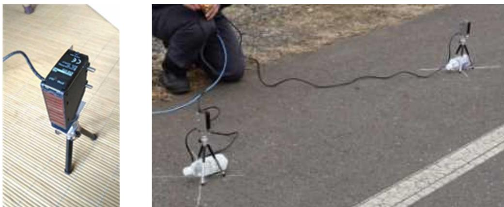
図 7-5 車両通過検知センサ、停止位置検出用センサ
