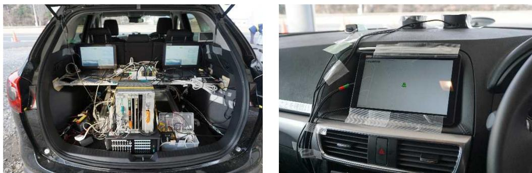
図 6-3 ベース車両の計測機器搭載スペース
