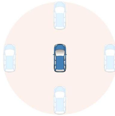
図 4-2-3 位置測位の誤差（濃色：実際の位置、淡色：測位された位置）
