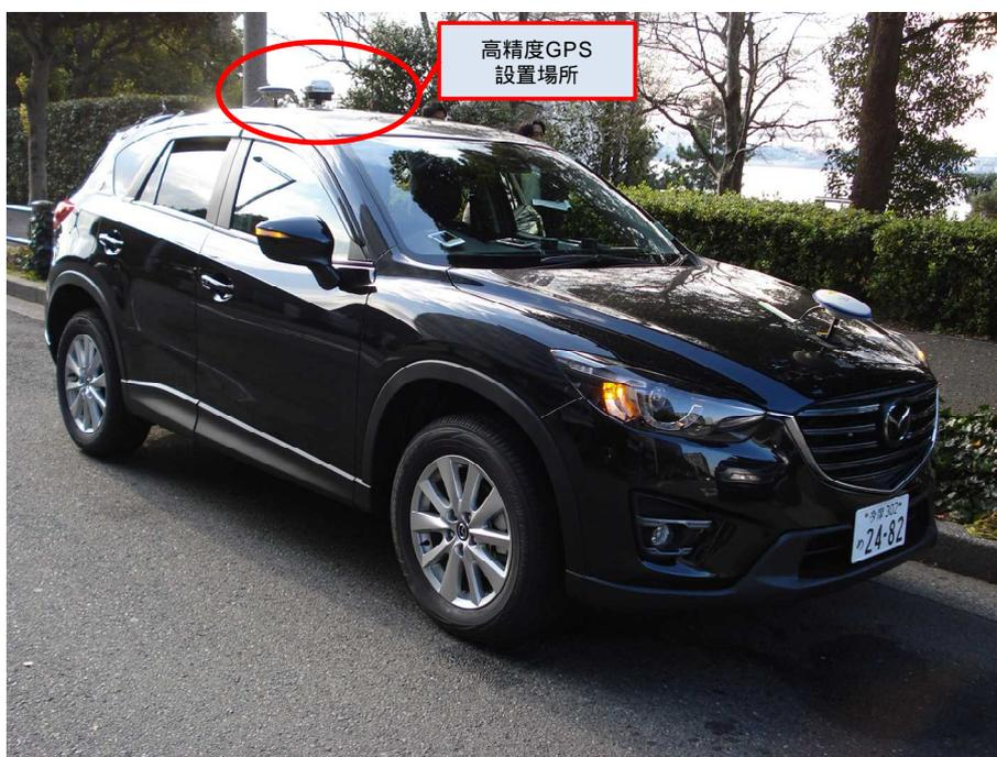
図 9-2-10 お台場における高精度 GPS の設置
