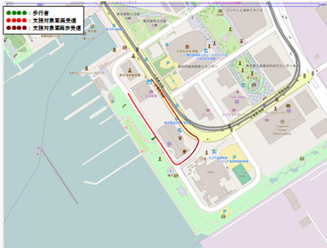
図 9-1-17 試番 20 車載器、専用歩行者端末間の送受信状況
