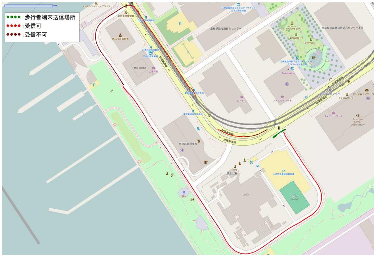
図 9-2-103 【車側・交差点】700MHz 帯通信の受信状況 試番 11
