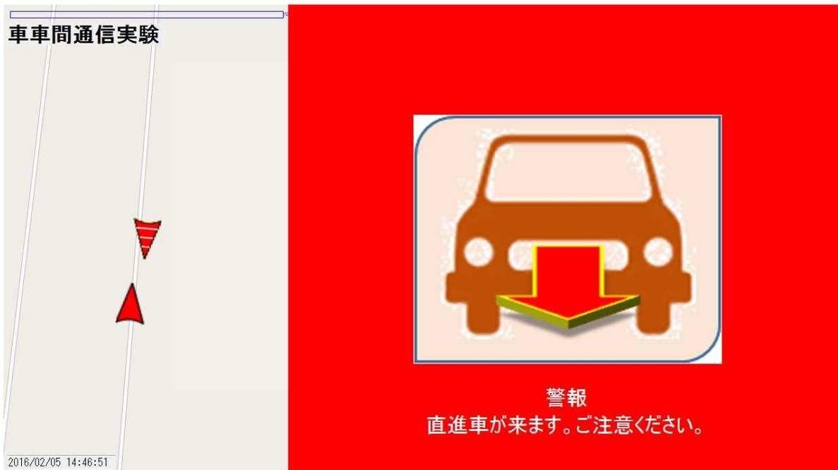
図 5-10 車車間通信システム支援モニタ画面イメージ
