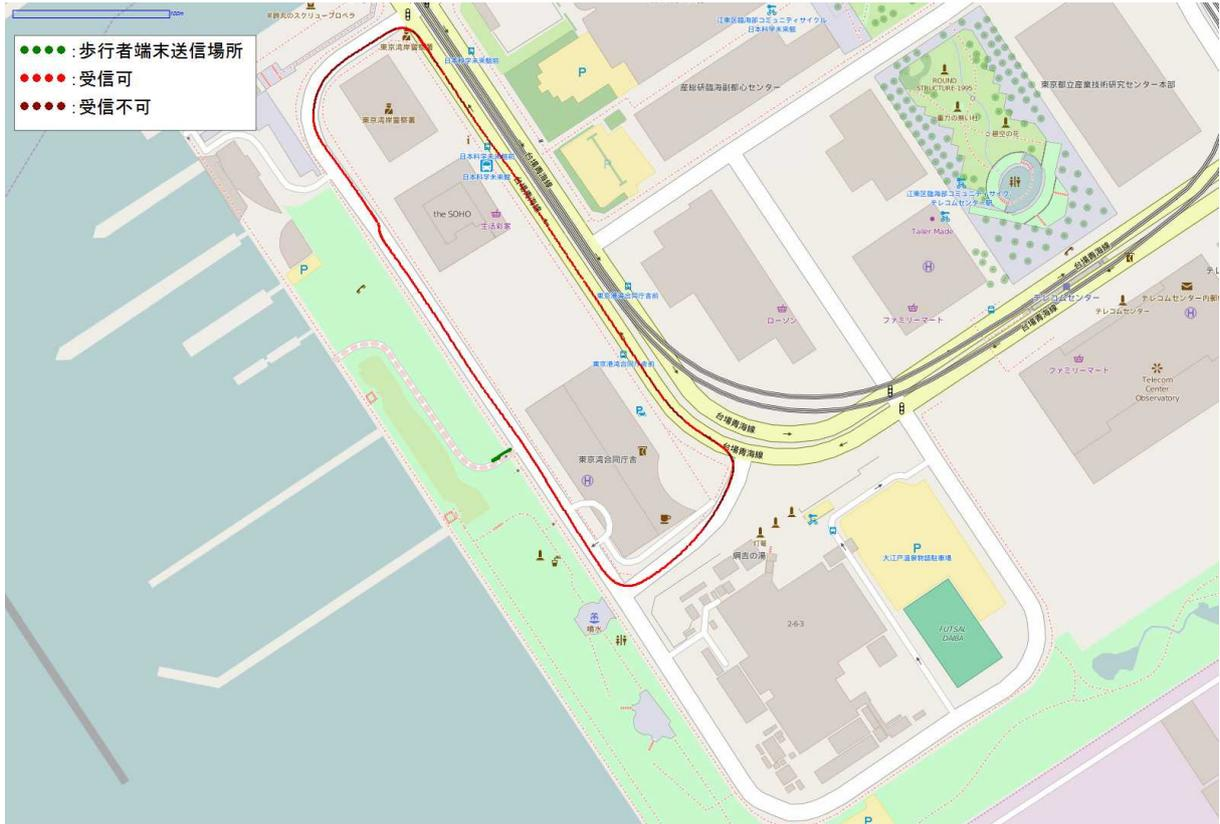
図 9-2-113 【歩側・交差点】700MHz 帯通信の受信状況 試番 16
