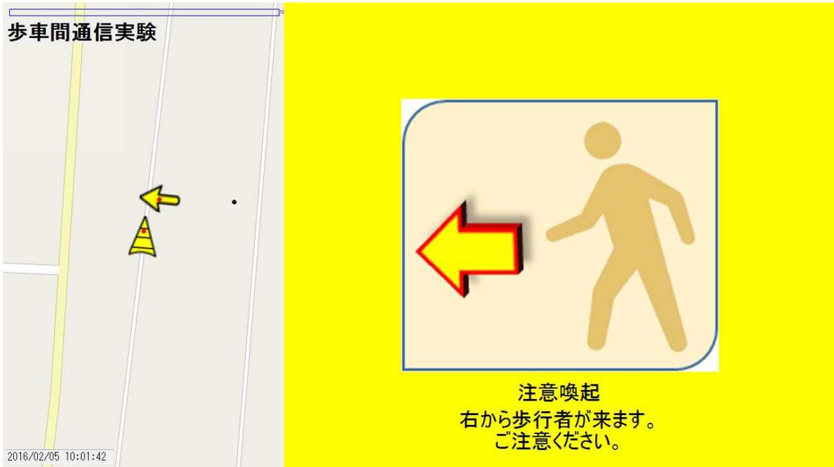
図 5-12 歩車間通信システム車両用支援モニタ画面イメージ
