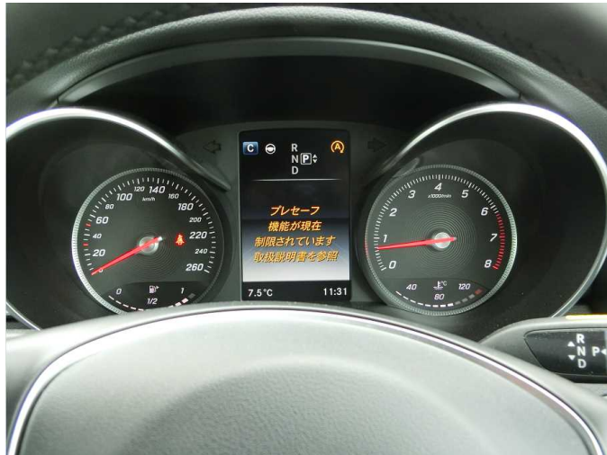
図 4.4 ステレオカメラ（片側）の汚れによって表示されるメッセージ
