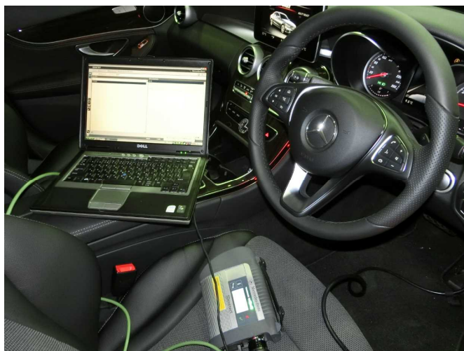
図 4.2 スキャンツールによる自己故障診断の検証
