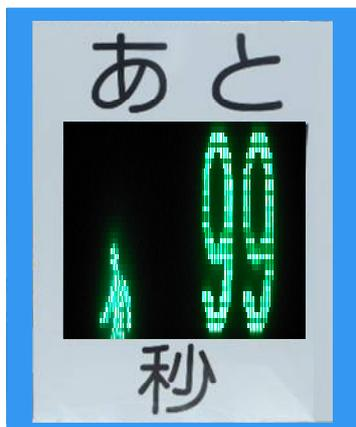
図 3-3 歩行者用交通信号残り時間表示装置外観図
